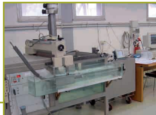
Sistema a 4 gradi di libertà per il controllo ultrasonoro di componenti. Nella foto il sistema sta ispezionando il tubo del divertore.
