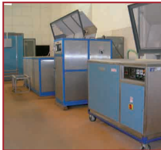
Camere climatiche e camere a nebbia salina per qualifica ambientale di componenti e sistemi nucleari
