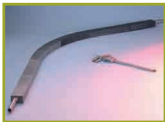
Tubo in rame con tegole in tungsteno e CFC (Carbon Fiber reinforced Carbon) del Divertore componente del reattore ITER
