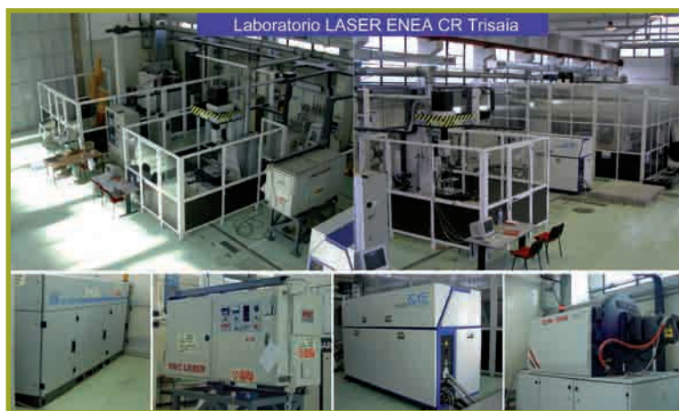
La hall tecnologica di circa 400 m 2 ospita 4 stazioni di lavorazione e 4 sorgenti laser con potenze comprese fra 1,8 e 6 kW utilizzate per lo sviluppo di processi di saldatura, trattamenti superficiali e la realizzazione di prototipi e piccole serie
