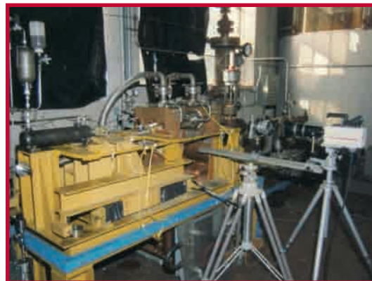
Impianto IETI: prove di scambio ad elevatissimi flussi termici (fino a 37 MW/m 2 )
