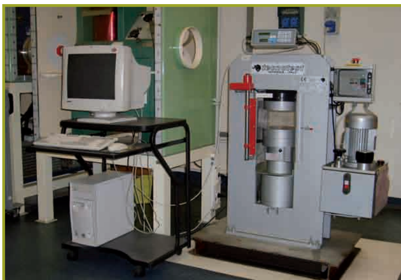
Resistenza a compressione Pressa Tecnotest KC 150
