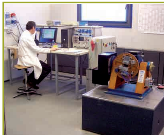
Sistema STASI per la taratura di accelerometri (frequenze 0,01 ÷ 10 Hz)
