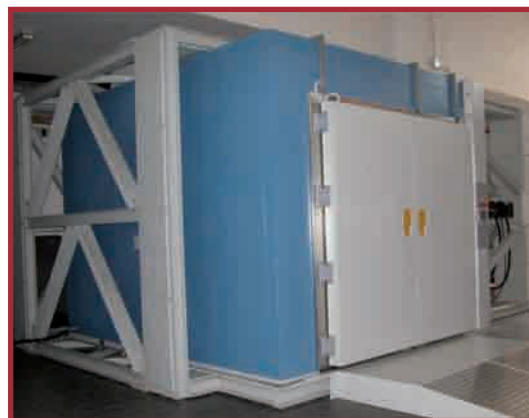
Camera Climatica per prove combinate di cicli termici, sollecitazioni meccaniche e irraggiamento UV
