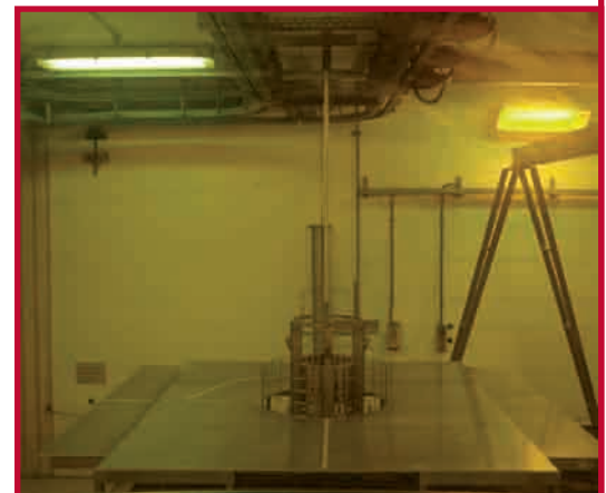
Vista della cella di irraggiamento e della rastrelliera contenente le sorgenti di ^{60}\text{Co} ; in primo piano la piattaforma per il posizionamento dei campioni
