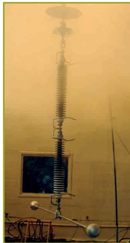
Prova su un isolatore in nebbia salina
