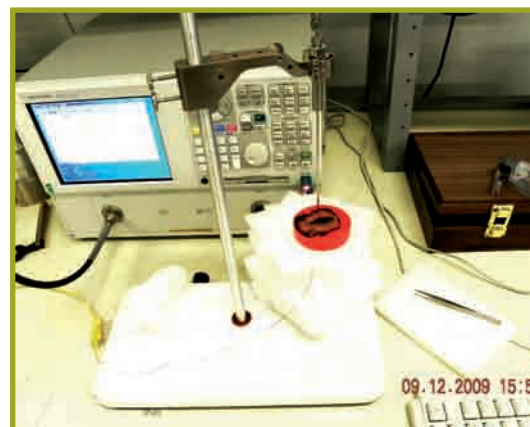
Caratterizzazione elettromagnetica di un campione di fegato bovino sottoposto ad ablazione a microonde
