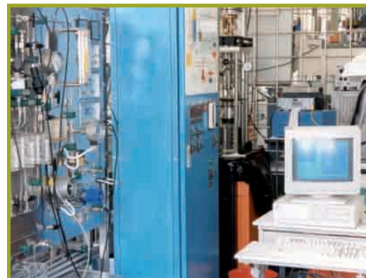
Circuito a ricircolo con autoclave per prove meccaniche in acqua ad alta temperatura e pressione: circuito bassa temperatura per il condizionamento e controllo della chimica dell'acqua
