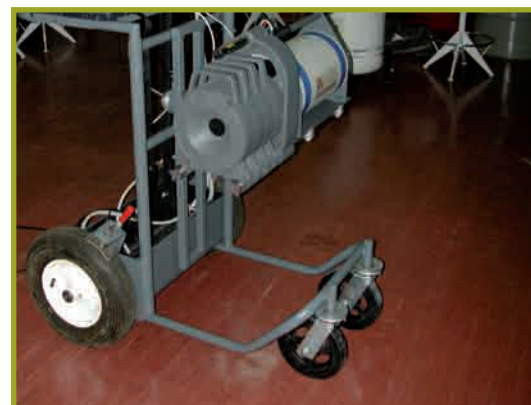
Misure su campioni di varie geometrie contenenti gamma-emettitori: Sistema di misura ISOCS (In Situ Object Counting System)
