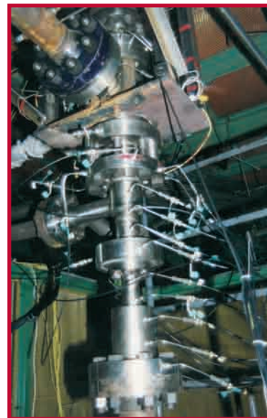
Impianto IETI: prove di steam injector CISE per iniezione passiva in LWR (pressione: 20÷90 bar)
