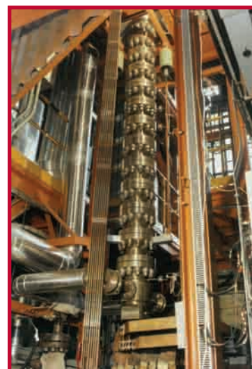
Prove di crisi termica su fascio di barre reattore BWR (potenza: 10 MW; pressione: 70 bar)
