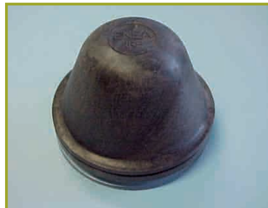
Dispositivo per il campionamento passivo del radon (brevetto ENEA, MI2006A000703)
