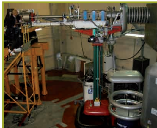
Esecuzione di prove di caratterizzazione RadHard di sensori FBG presso l'impianto Frascati Neutron Generator del Centro Ricerche ENEA di Frascati
