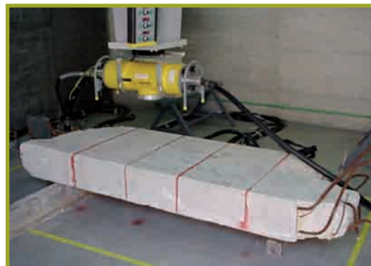
Apparecchio radiografico 20÷450 kV, 15 mA
