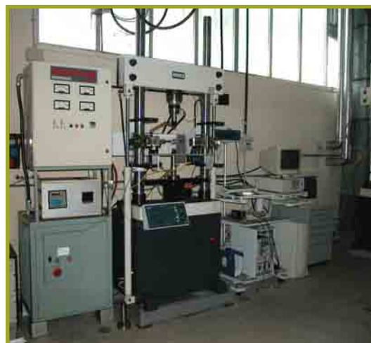
Macchina Universale Mayes da 100 kN per fatica termo-meccanica (riscaldamento induttivo)
