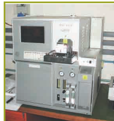
Analizzatore di idrogeno LECO RC412 modificato, uno dei componenti del dispositivo prototipo per prove di infragilimento da idrogeno con caricamento elettrochimico in-situ
