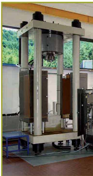
Macchina per fatica compressiva da 8000 kN
