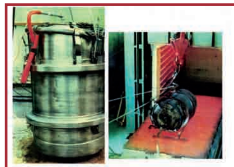
Contenitore di rifiuti radioattivi dopo la prova di caduta da 9 m e invecchiamento termico a 800 °C per 30 minuti
