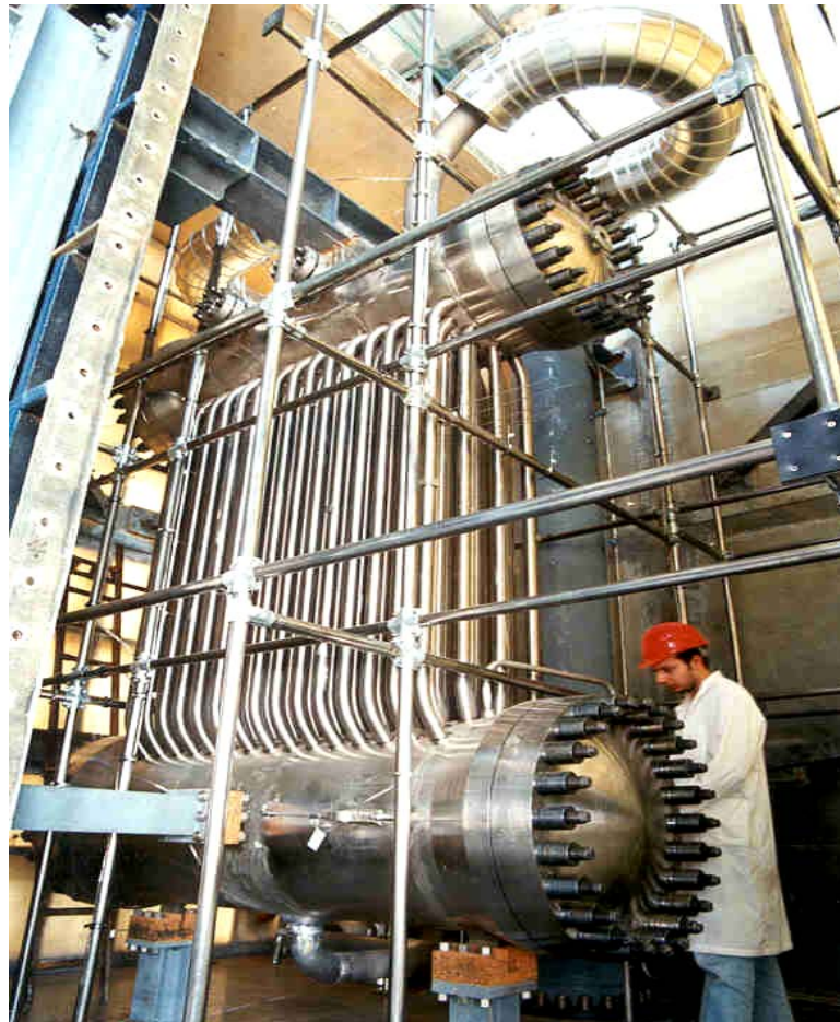
Figura n. 28 - Facility PANTHERS: Isolation Condenser
