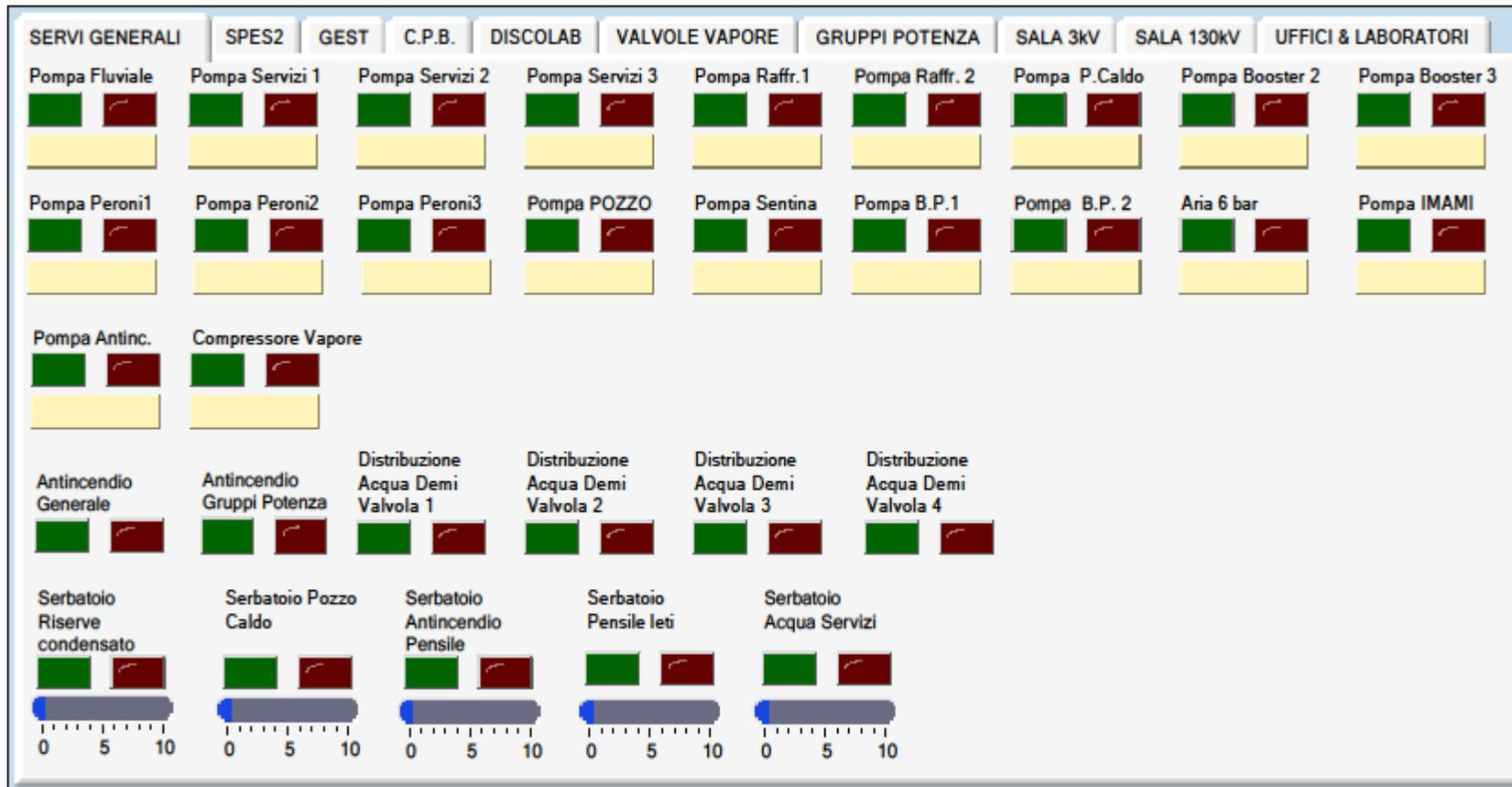
**Fig. 3.3 – Pannello frontale della routine di comunicazione tra Profibus e LabVIEW e codice software**
