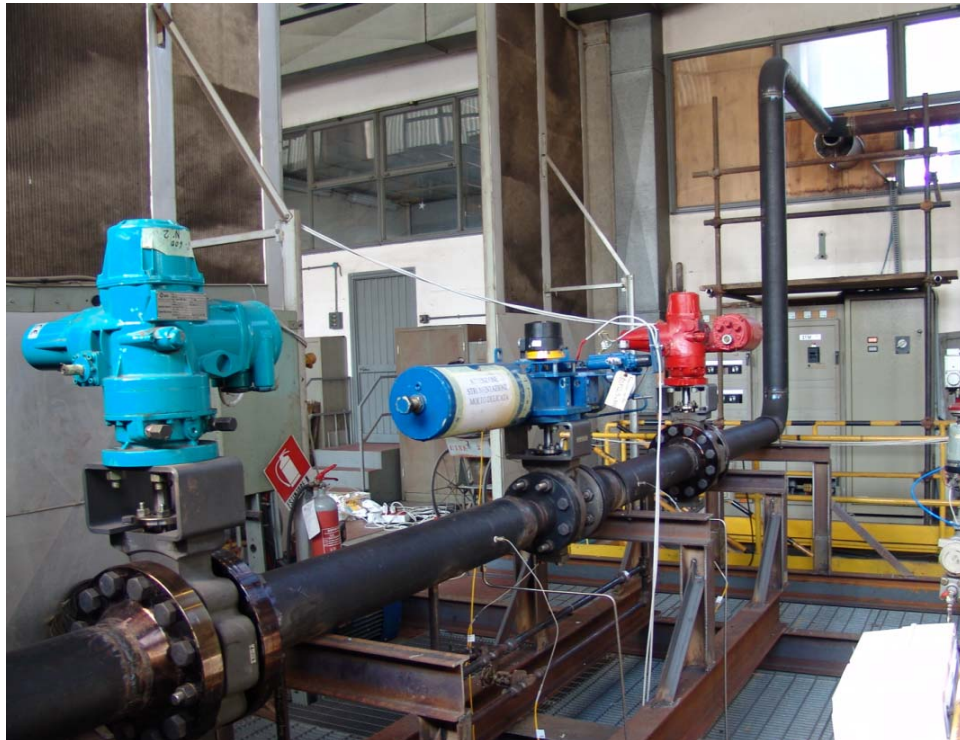
Figura 45 - PROVE DI FUNZIONALITA' IN VAPORE SU VALVOLE DI INTERCETTAZIONE A FARFALLA SU IMPIANTO GEST
