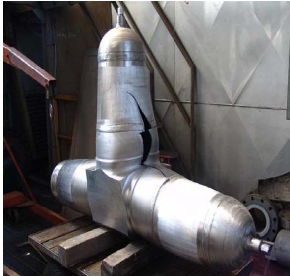
Figura 49 - PROVA DI SCOPPIO RACCORDO 12" PER PWR
