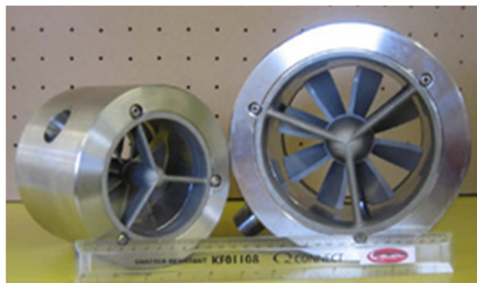
Figura 30 - TURBINA PER MISURA DI PORTATA VOLUMETRICA
