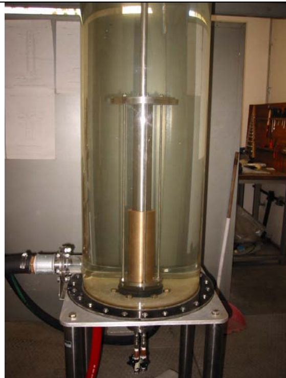
Figura 25 - SEZIONE DI PROVA PER TEST SU BARRE IDRAULICHE
