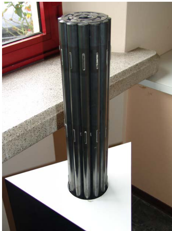
Figura 55 - SIMULATORE DI ELEMENTO COMBUSTIBILE CIRENE
