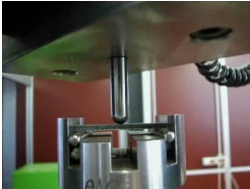
Fig. 9 – Assetto per la prova di flessione a 3 punti
