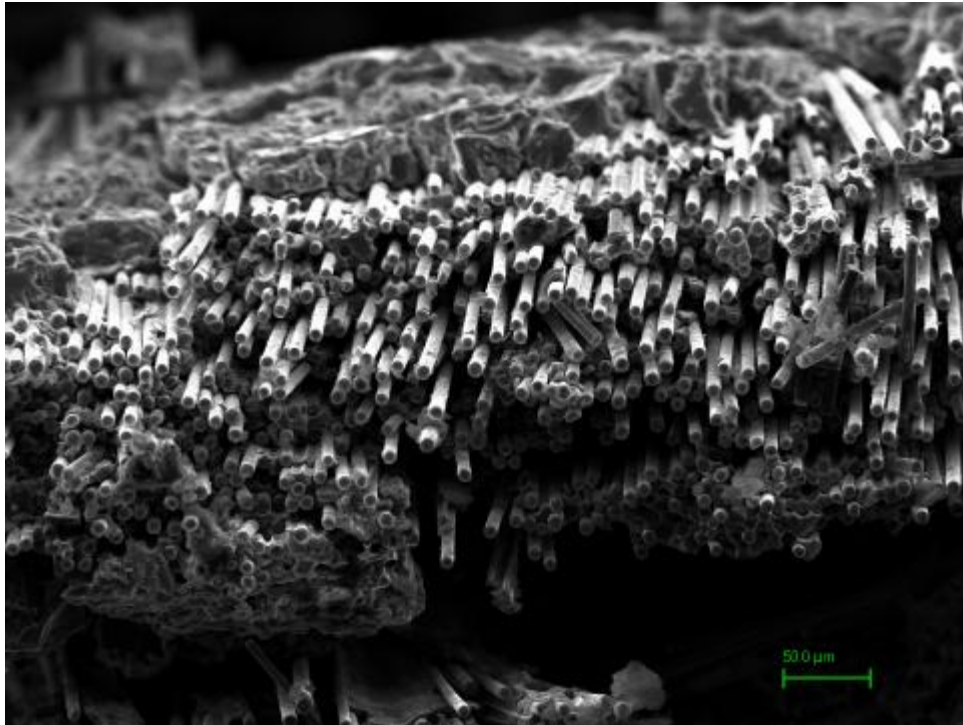
Fig. 15 – Ingrandimento della parte in frattura (500X)
