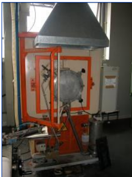
Fig. 66 – Forno ITEM per trattamenti di PIP
