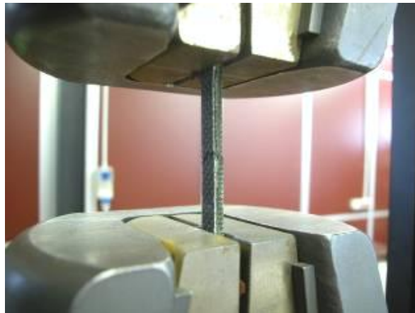
Fig. 6 – Provino TV1/3 alla fine della prova: rottura perfettamente centrata nella zona utile
