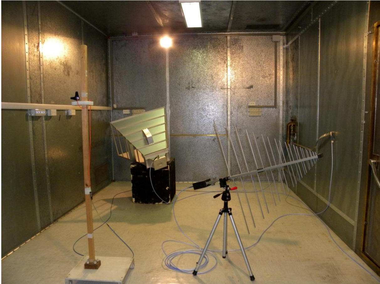
Figura 13 - Vista attuale dell'allestimento interno della camera "Echo" (l'agitatore-sintonizzatore non è installato)
