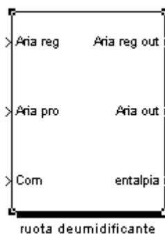
Figura 23: Modello ruota deumidificante in linguaggio Simulink
