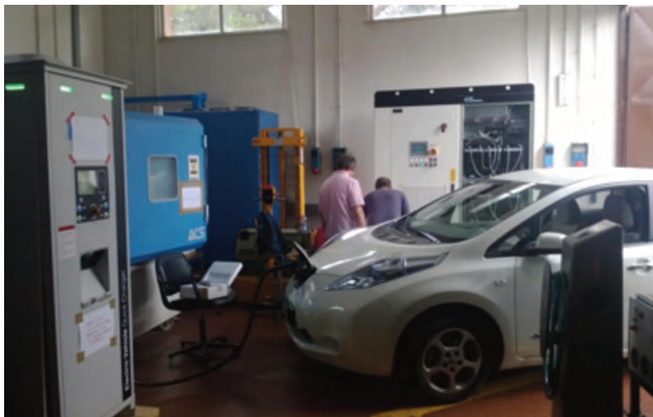
Test al banco del prototipo di caricatori integrali e apparato sperimentale stazione di ricarica combinata
