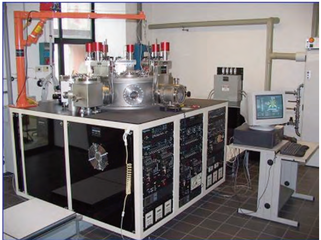
Impianto multicamera utilizzato per la fabbricazione di materiali e celle solari a film sottile di silicio
