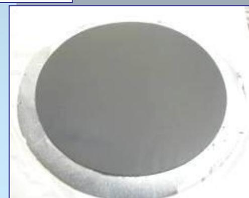
Campione ( $\varnothing$  170 mm) di anodo pressato a caldo
