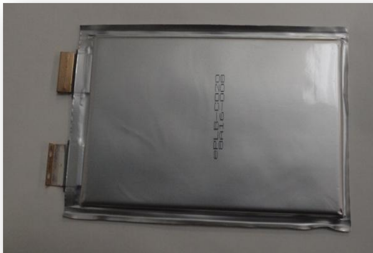
Cella di prova EIG da 20 Ah
