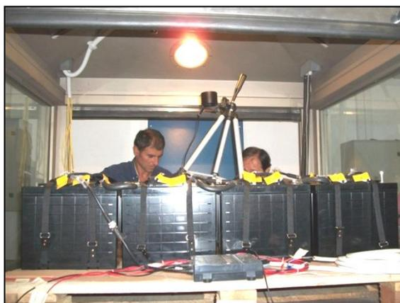
**Figura 13. Misure della velocità dell'aria effettuate con anemometro a ventolina posto all'interno della cappa A.**
