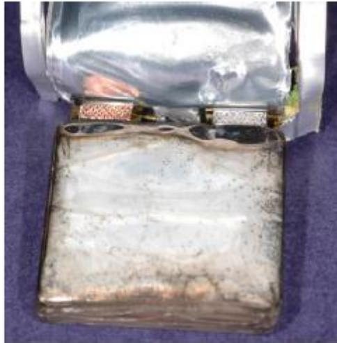
**Figura 2. Esempio della fusione del separatore dovuto ad abuso elettrico**
