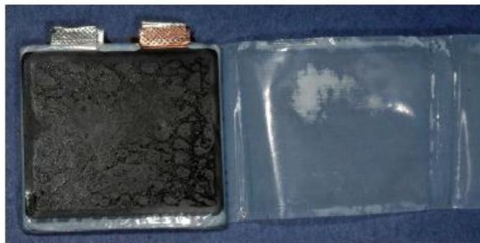
**Figura 1. esempio di una cella prismatica aperta**
