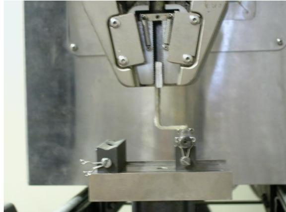
Fig.24 fotografia della prova sull'elemento stampato
