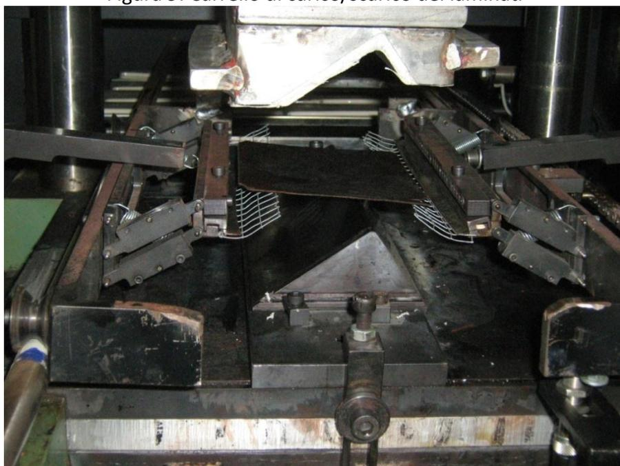
Figura 10: Laminato pronto per la fase di formatura
