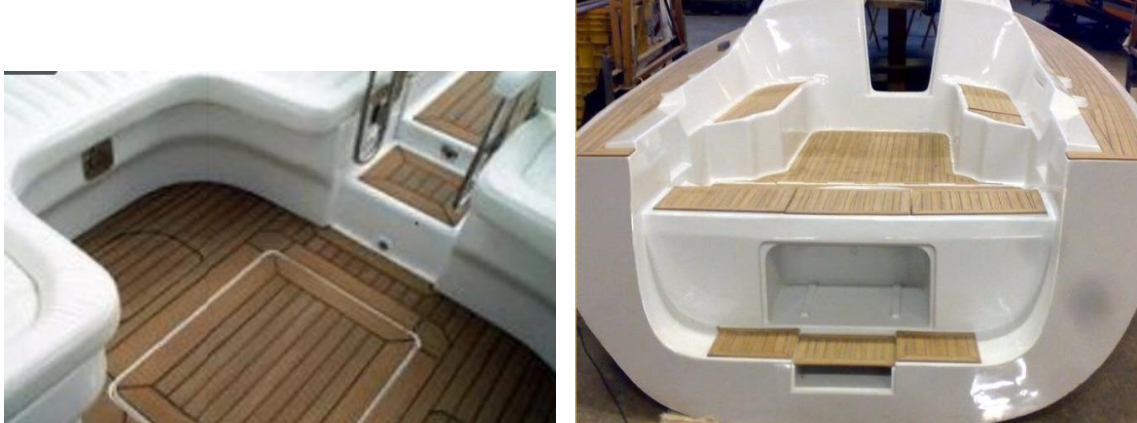
Fig. 2.16 Impiego di WPC in imbarcazioni
