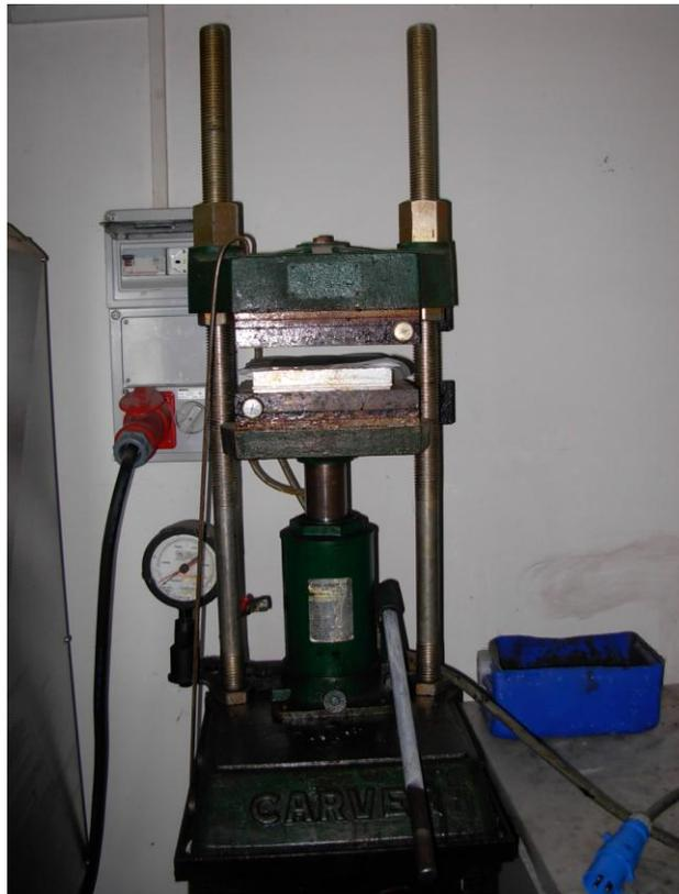
**Fig. 15.** Posizionamento in pressa dello stampo.
