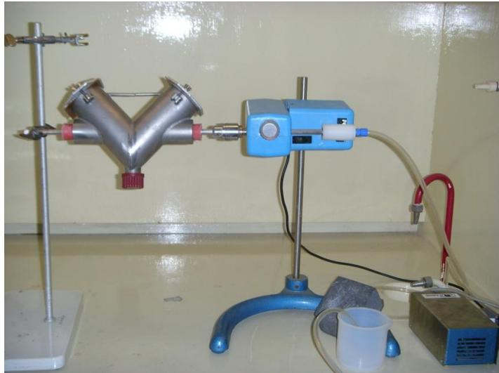
Figura 1: Granulatore da laboratorio
