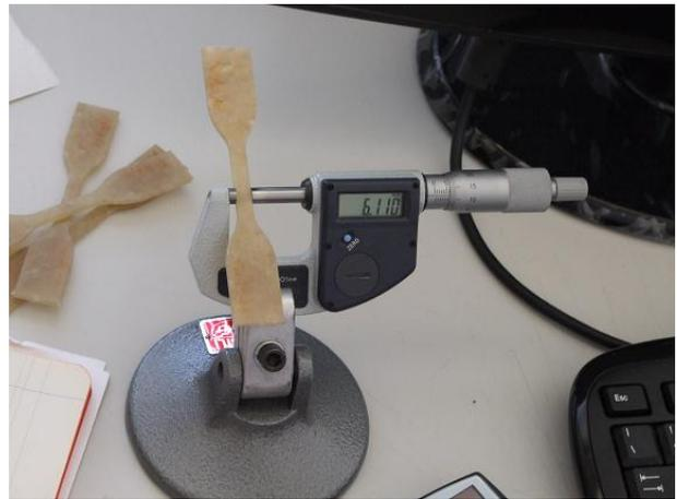
Fig.12 Controllo dimensionale dei provini ricavati
