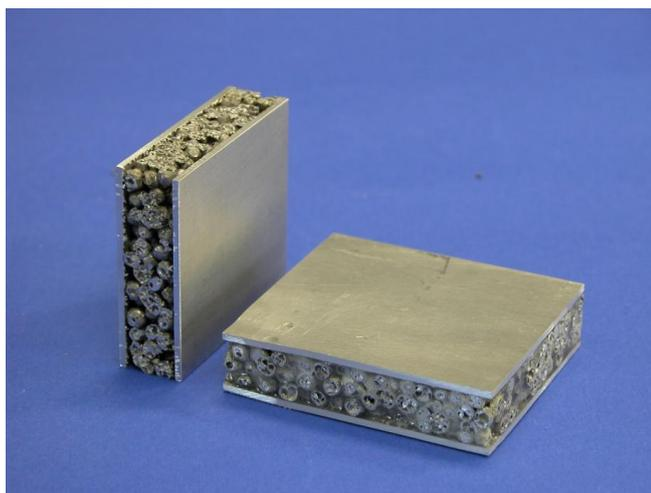
Figura 6: Campioni di materiale cellulare per prove meccaniche di compressione
