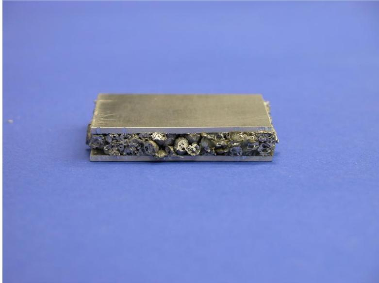
Fig. 8. Campione 1 dopo prova di compressione
