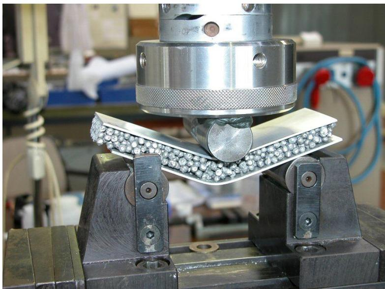
Fig. 10. Campione 0 dopo prova di flessione
