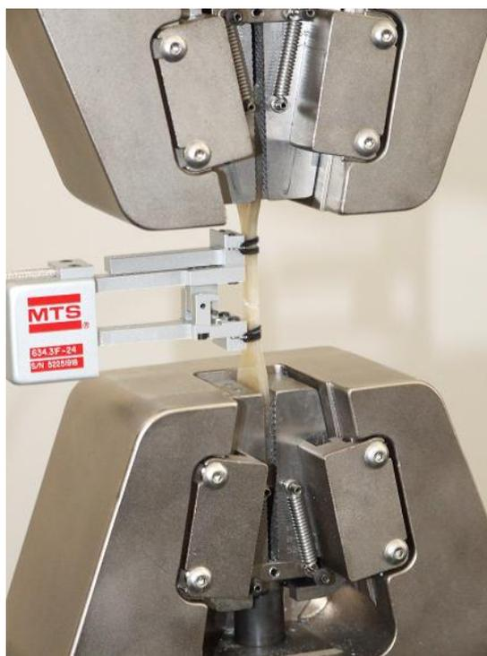
Fig.13 Particolare della prova a trazione eseguita
