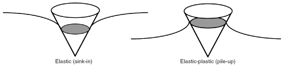
Figura 6: SX Sinking-in: tipico dei materiali ad elevato rapporto H/E (i.e. Fused Silica o i campioni di marmo); DX Piling-up: tipico dei materiali a basso rapporto H/E (i.e. metalli duttili o polimeri)
