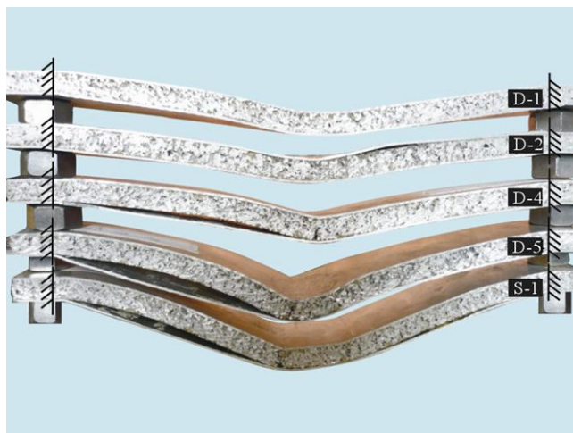
Fig. 63: profili di deformazione dei sandwich con cuore in schiuma di alluminio a cella aperta [53].
