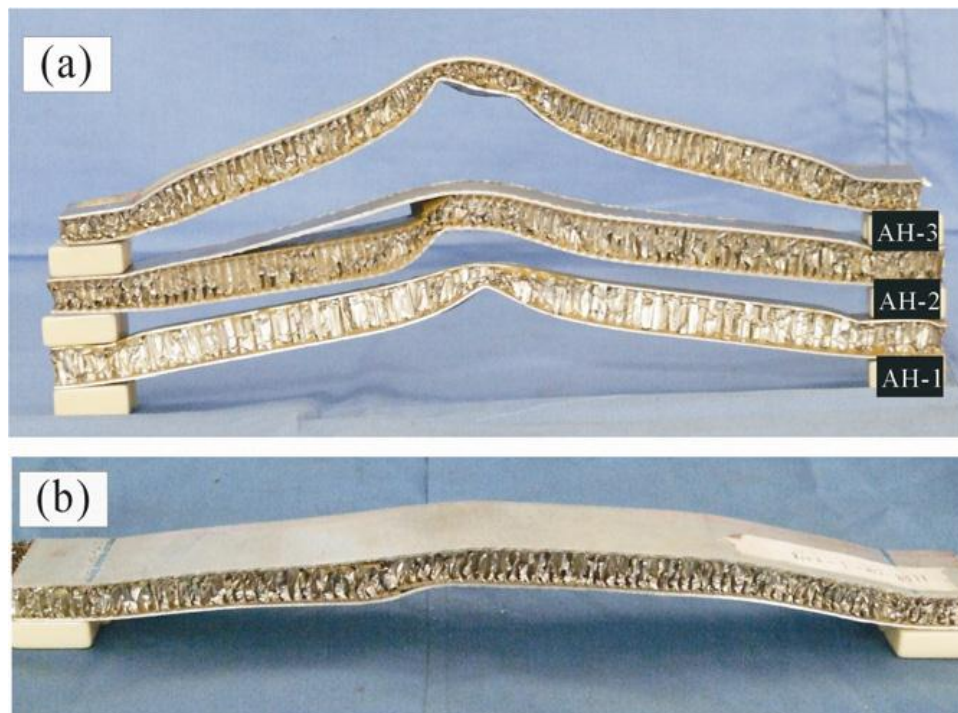
Fig. 61: risultati sperimentali per i sandwich con cuore in struttura honeycomb. a) profili di deflessione a diversi valori di carico dinamico; b) profilo di una lastra sottoposta a carico quasi – statico [52].
