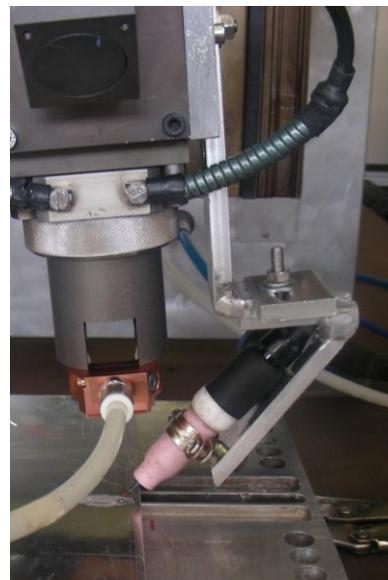
**Figura 10: Schema di saldatura Laser TIG.**
