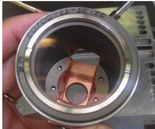
**Figura 6: Set Up con lama d'aria (pressione 5 Bar); a DX il controllo dello stato de vetrino di protezione dopo 10 prove non mostra segni di spatter ad indicare una buon efficienza di protezione della lama d'aria.**
