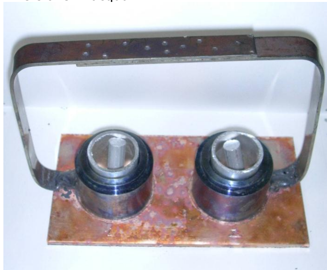
Figura 18: Porta campioni in rame ed Inox per l'alloggiamento simultaneo dei due tipi differenti di precursori.
