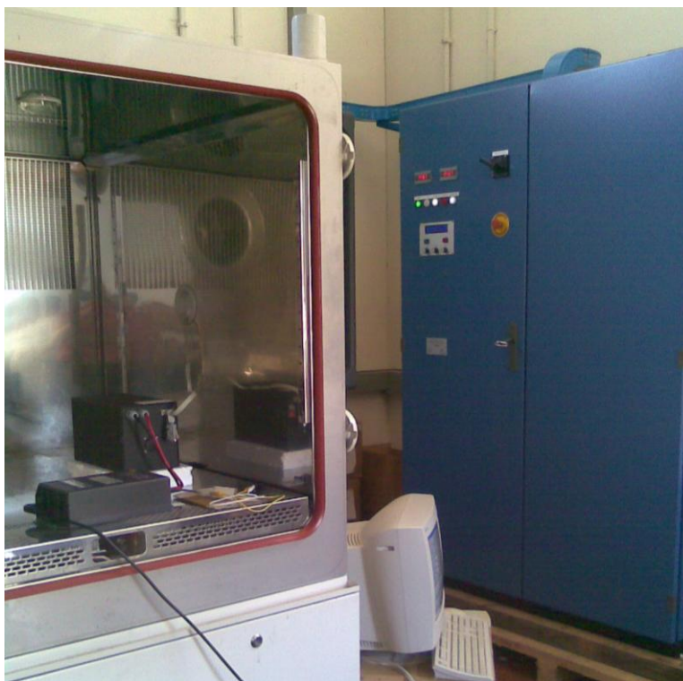
Figura 61 – Camera climatica (sinistra) e ciclatore (destra) usati per i test del sistema 48V – 20Ah
