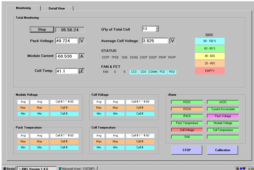
Figura 70 – Schermata del BMS durante la prova di scarica a corrente massima
