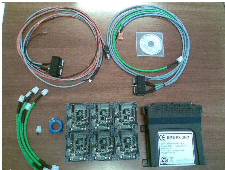
Figura 19 - Componenti del BMS acquistato
