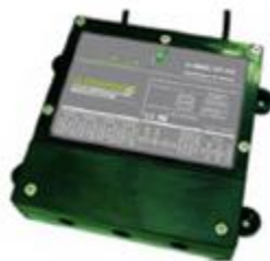
Figura 37 - BMS di sistema
