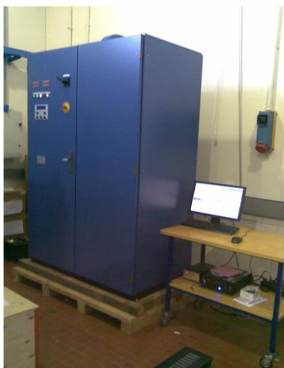
Figura 39 - Ciclatore (sinistra) e camera climatica (destra) usati per le prove
