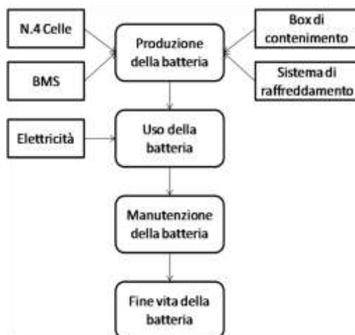
Fig. 1: – Confini del sistema della batteria
