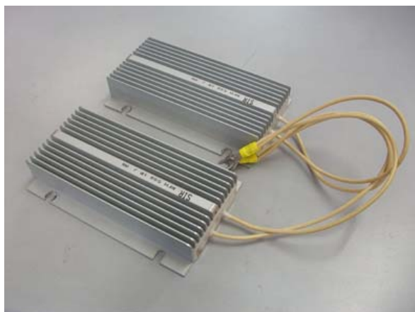
Fig. 6.2.5) La resistenza di frenatura è costituita da n. 2 resistori da 1Ω, 1kW collegati in parallelo
