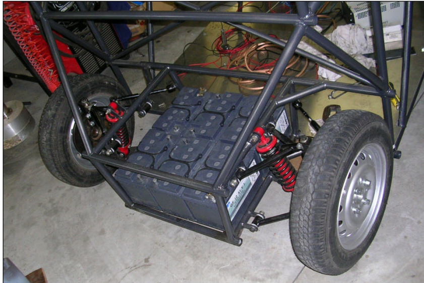
Figura 26 - Assemblaggio delle batterie per la versione puramente elettrica
