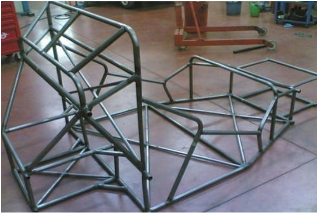
Figura 9 - Il telaio ed il rolling chassis
