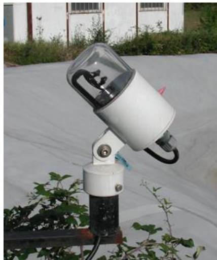
Figura 34 disegno e immagine dell'eliofanometro.
