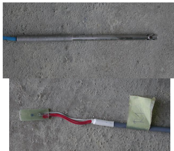
Figura XX termoresistenze per la misura della temperatura dell'aria e per la misura della temperatura superficiale.
