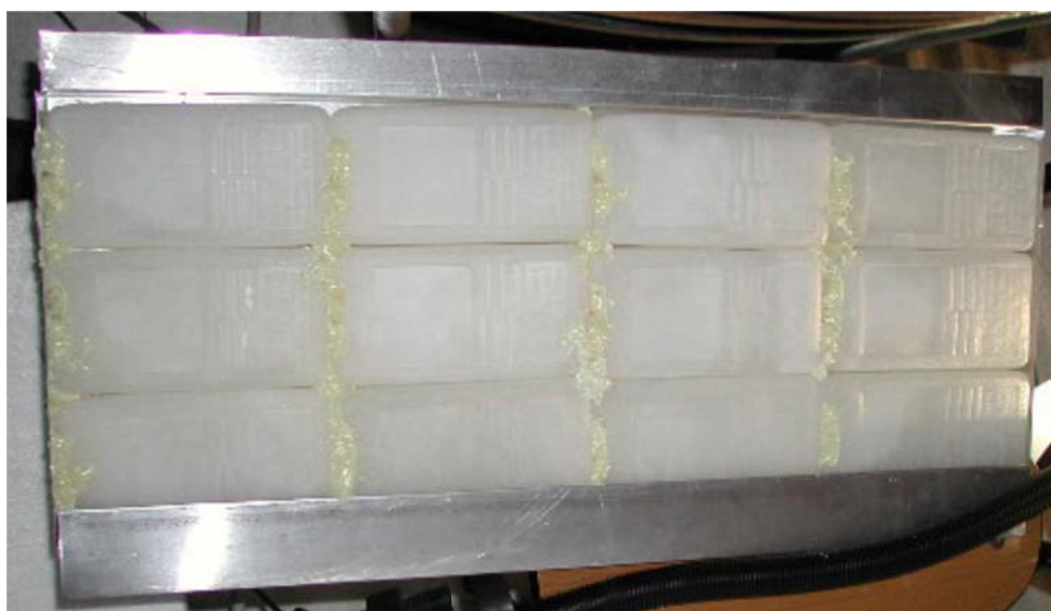
Figura 6 PCM contenuto in contenitori polimerici
