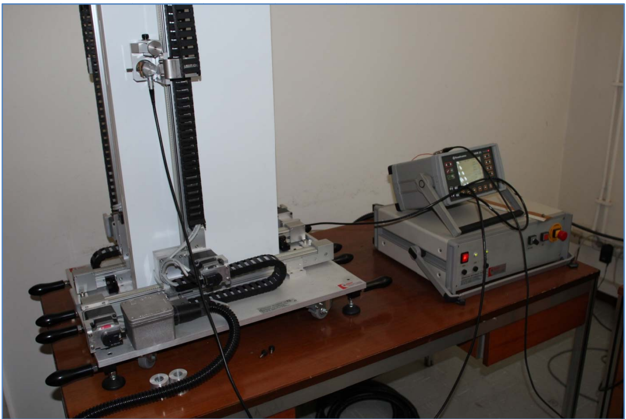
Figura 19. Sistema di movimentazione e strumento Ultrasonoro
