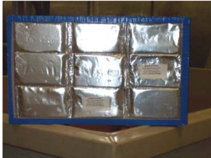
Figura 7 PCM contenuto in contenitori metallici flessibili
