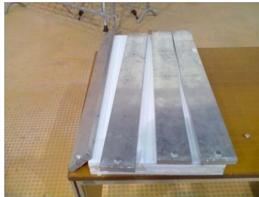
Figura 26 Pannello con PCM dopo il test su tavola
