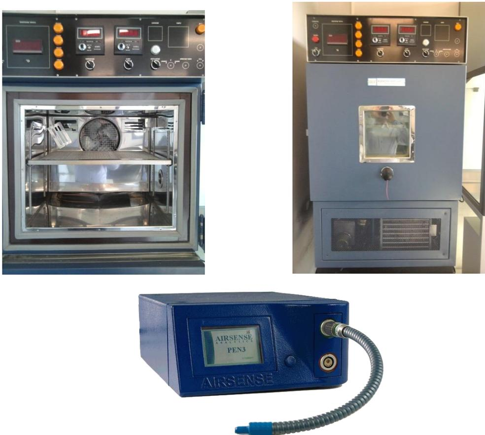
**Figura 27: Camera di test Angelantoni e naso elettronico Airsense PEN3**
