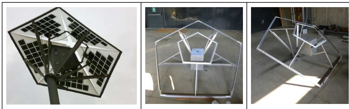
Figura 19. modello iniziale Stapelia e modifiche funzionali al contenitore per la batteria
