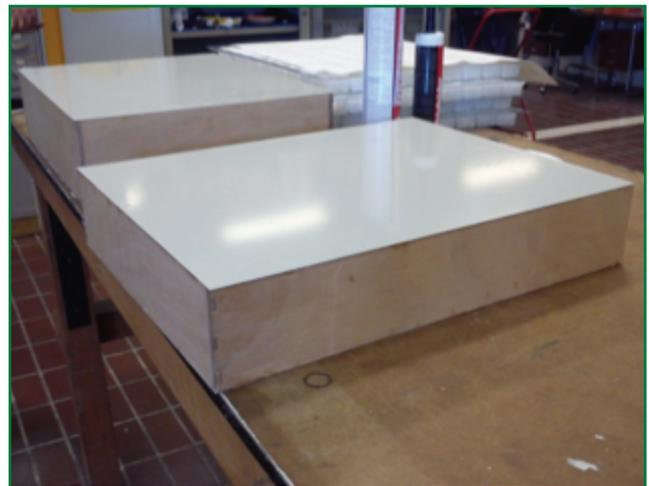
*Prototipo di pannello multistrato contenente materiale PCM*
