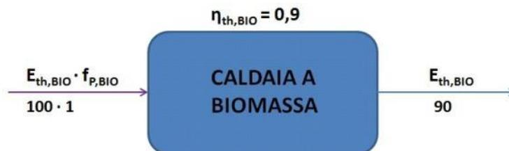
Figura 27 - Generazione tramite caldaia a biomassa
