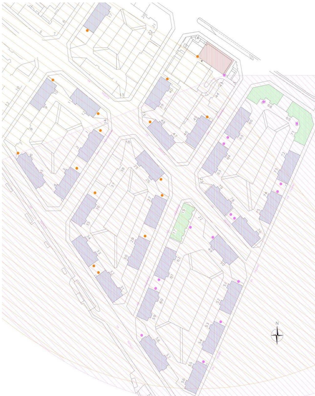
**Figura 48 - Dislocazione antenne e copertura radio**
