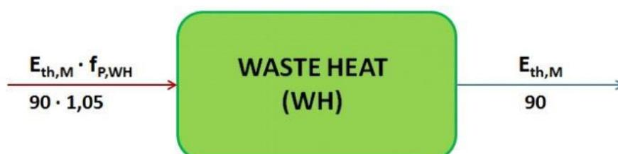
Figura 23 - generazione tramite sfruttamento di calore di scarto
