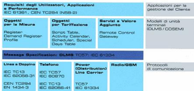
Figura 5: Struttura di un dispositivo DLMS compliant
