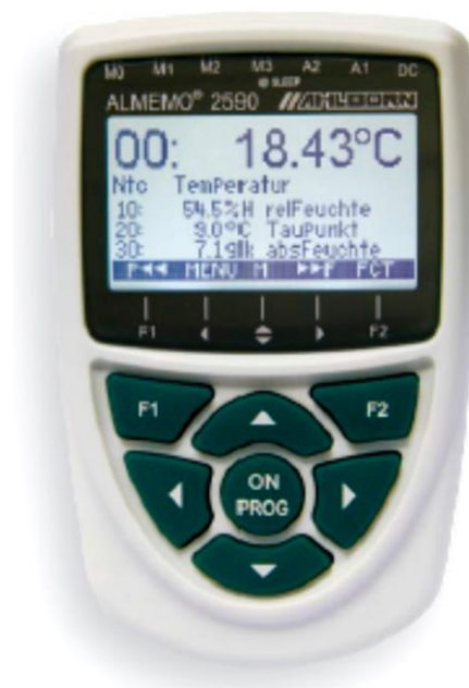
Figura 13. Logger di temperatura utilizzato nelle misurazioni in ambito alberghiero
