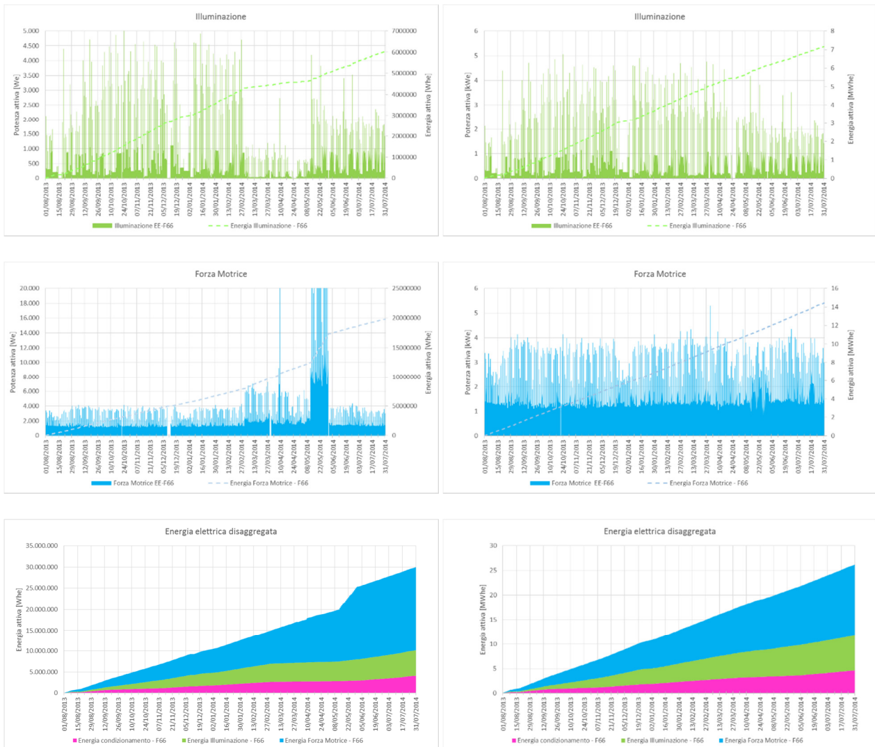
Figura 5: Operazione di correzione dei dati di potenza ed energia elettrica relativi all'edificio F66.
