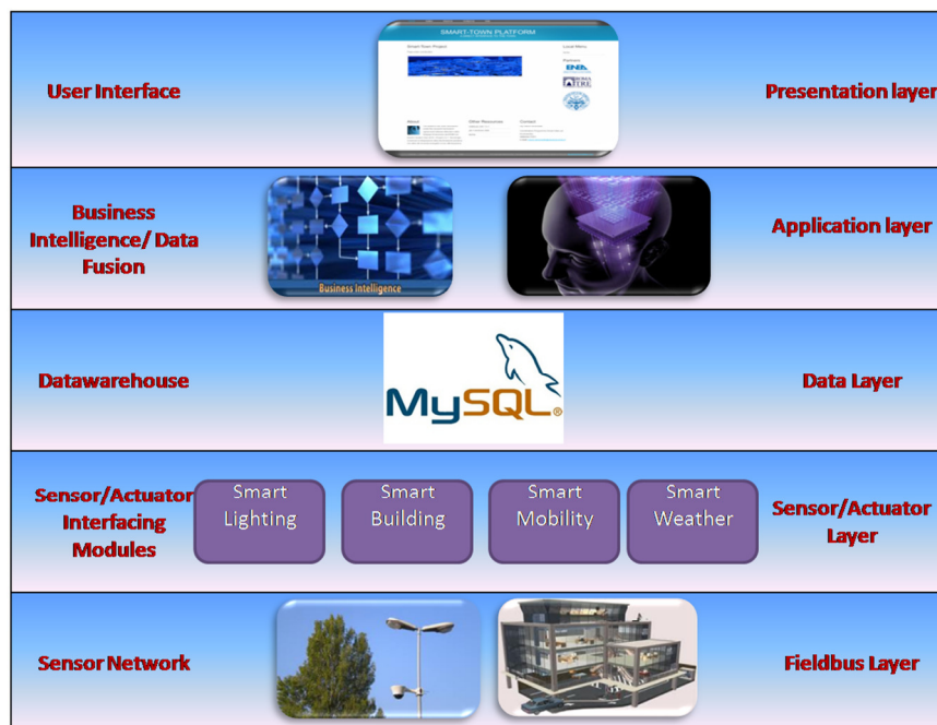
Figura 1. Struttura logica della Piattaforma SCADA
