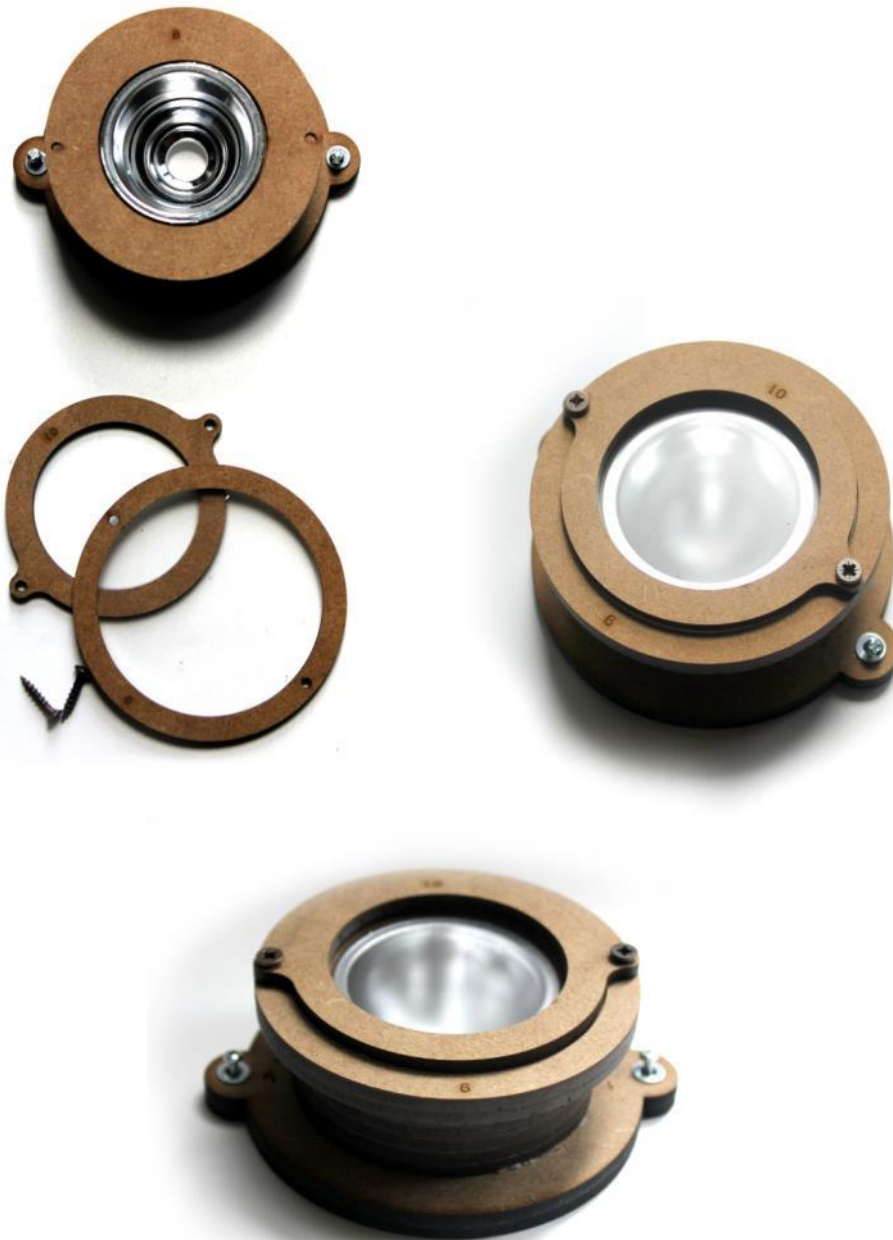
Figura 154 Sistema ottico per la Soluzione 03: riflettore Venla e diffusore olografico Luminit ( 10^\circ )
