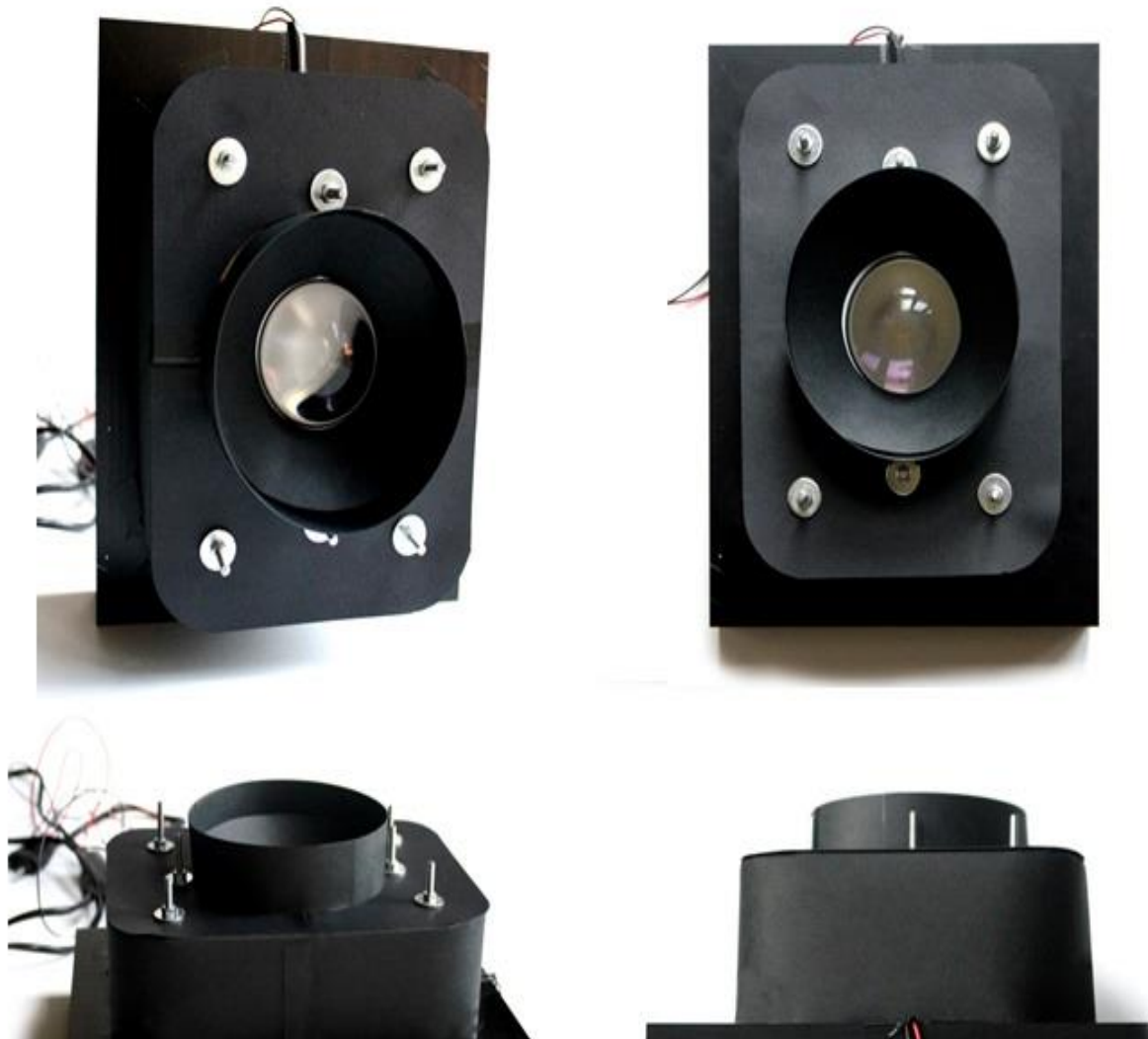
Figura 133 Soluzione 01: prototipo utilizzato per le misure di flusso (sistema completo e di ciascun componente)
