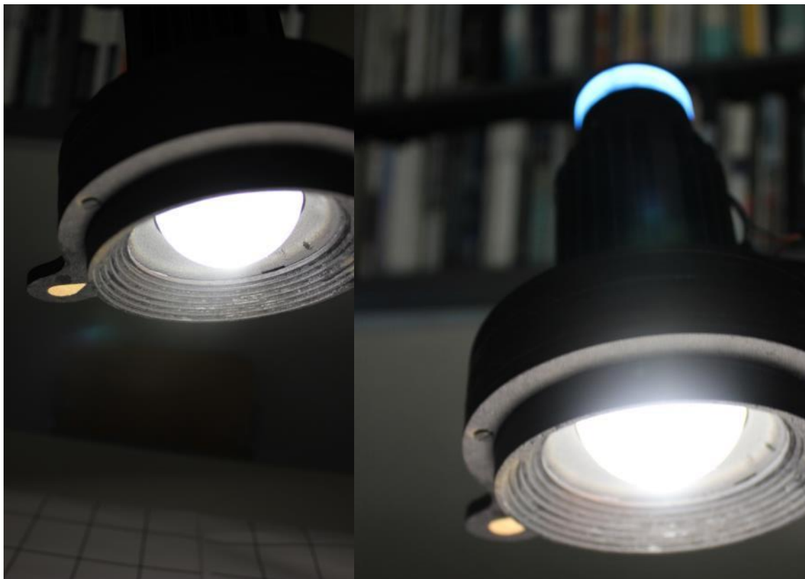
Figura 114 Particolari delle manopole con interfaccia e il sistema ottico della Lente Optotune versione narrow
