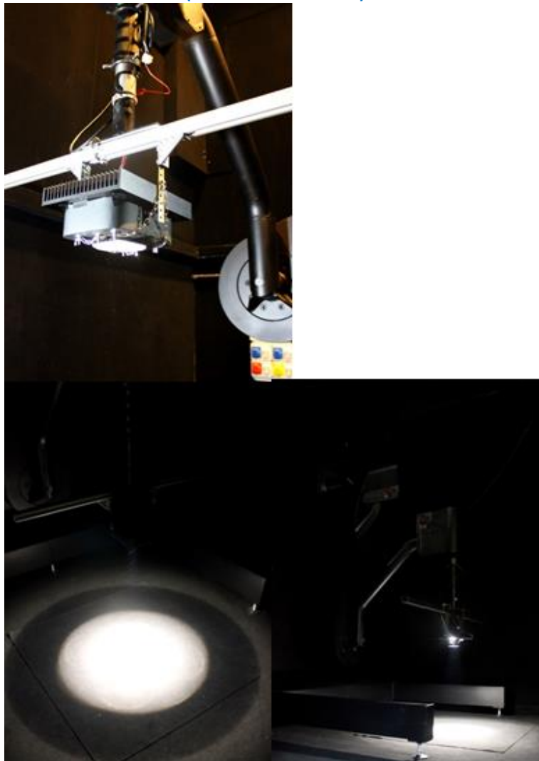
Figura 135 Soluzione 01 durante le verifiche fotometriche
