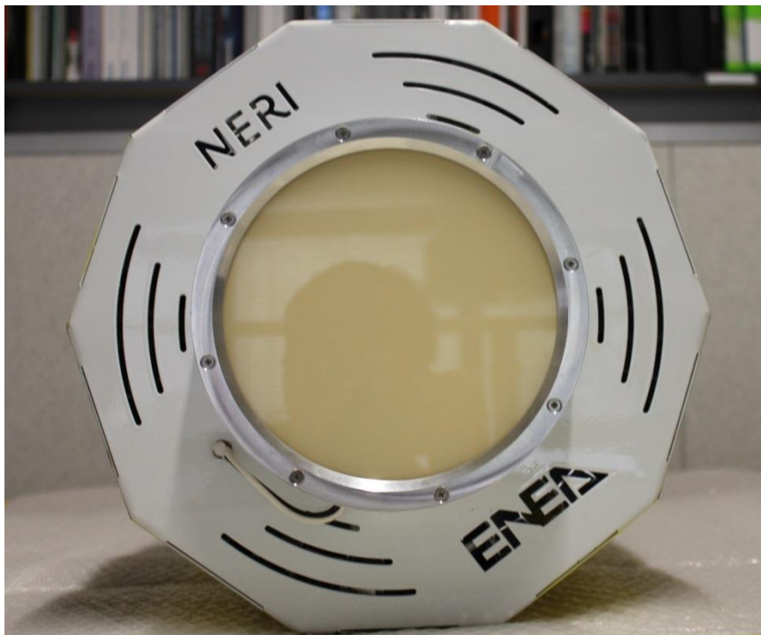
Figura 37 Dettaglio frontale HumbleBee, dove appaiono evidenti le feritoie del sistema di dissipazione
