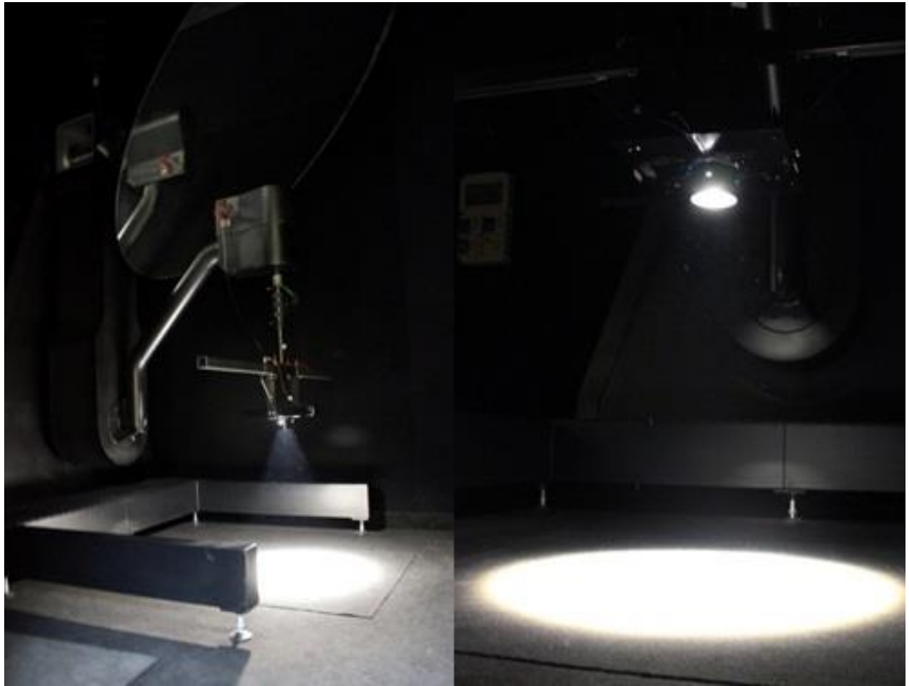
Figura 151 Misura prototipo di studio con lente di Fresnel
