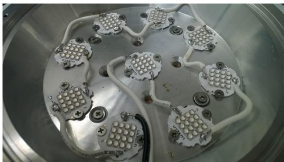
Figura 5: esempio di problema hardware. Alloggiamento dei LED privo di camera di miscelazione
