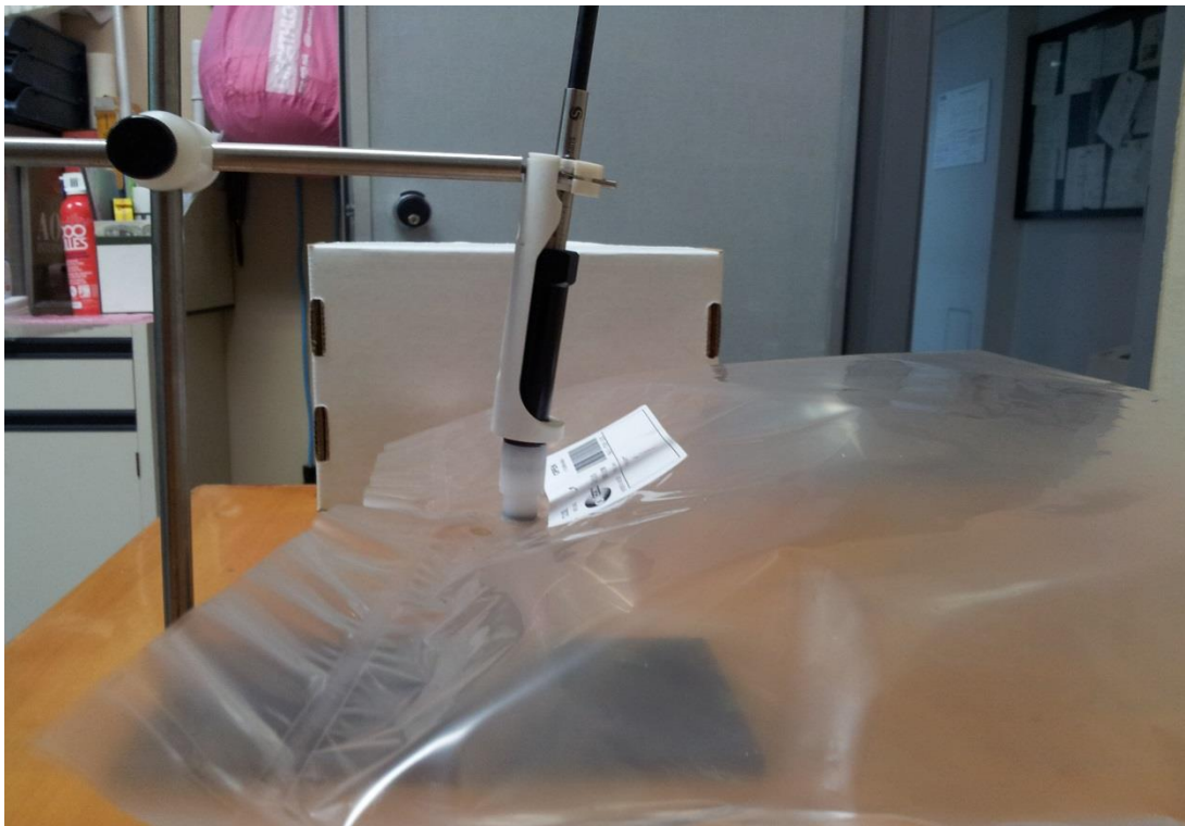
Figura 2.5.2: Campionamento dei VOCs emessi dalle pesche mediante Solid Phase Micro-Extraction, SPME.
