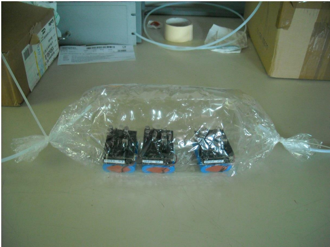
Figura 2.6.2: Alloggiamento dei nodi libelium durante la loro calibrazione con CO 2 , NH 3 , O 2 e (+)-Limonene
