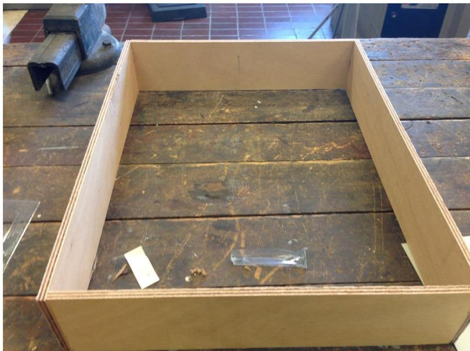
**Figura 2.2.3: Telaio in legno per realizzazione pannello multistrato.**
