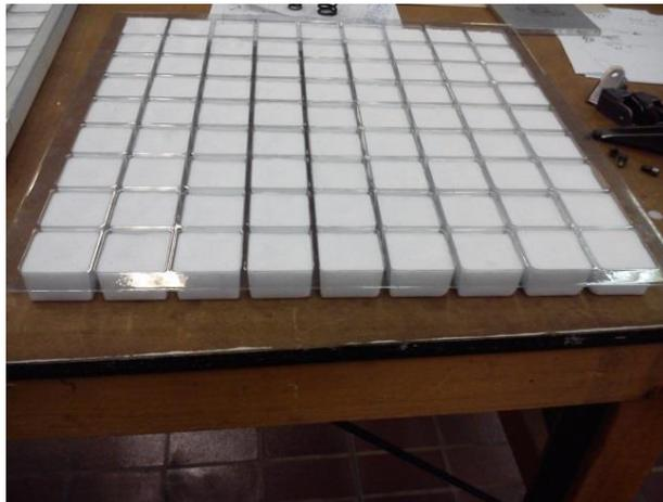
**Figura 2.1.4: Struttura di contenimento con PCM in fase solida.**
