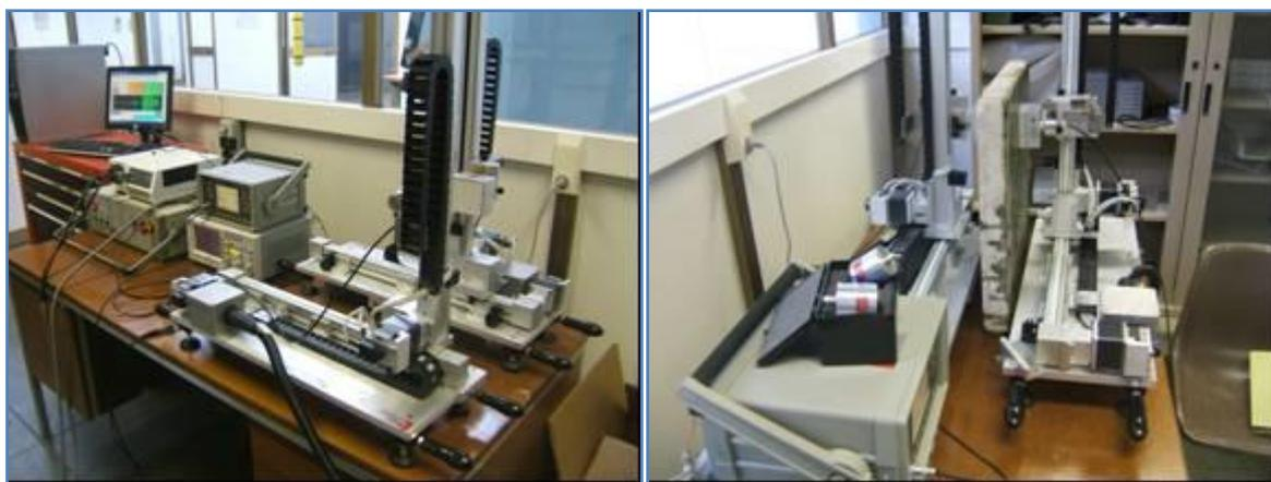
Figura. 2.6.1: Sistema automatico con sonde non a contatto
