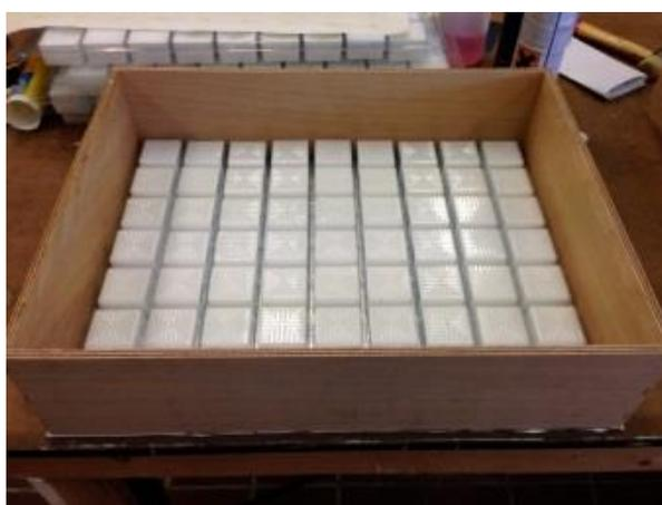
**Figura 2.2.7: Posizionamento struttura di contenimento del PCM all'interno del pannello**
