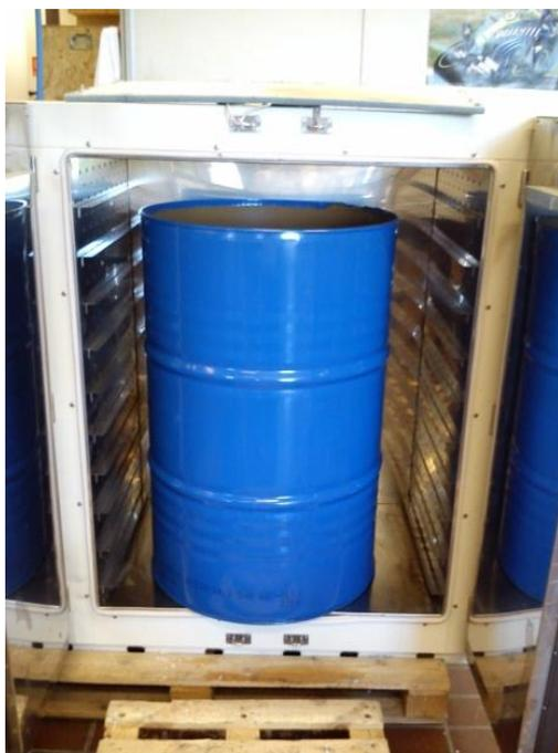
**Figura 42. Riscaldamento in forno per liquefazione**
