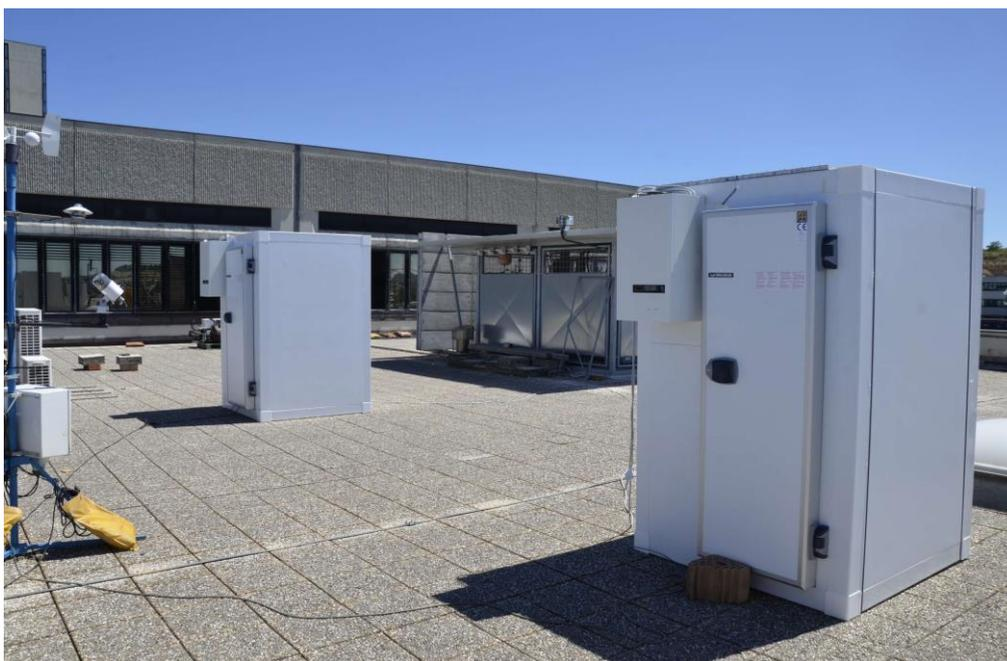
**Figura 1. Le celle frigorifere identiche installate sulla superficie all'aperto del Laboratorio di Energetica Ambientale**
