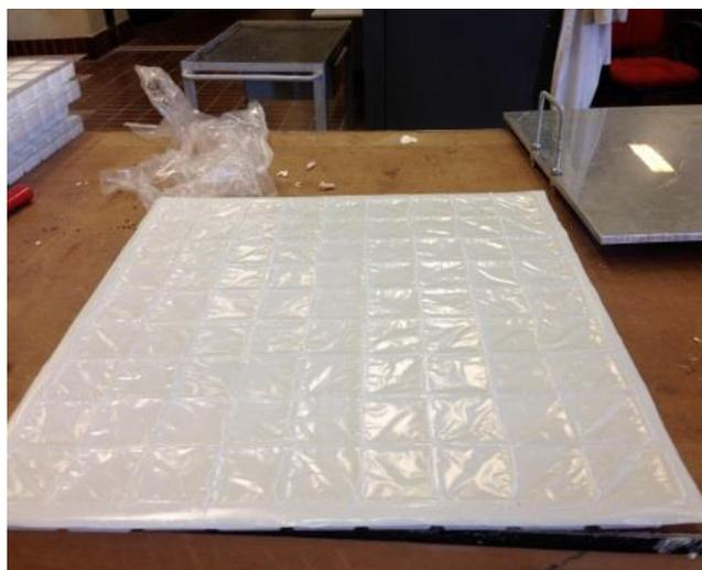
Figura 46. Il pannello sigillato contenente il PCM
