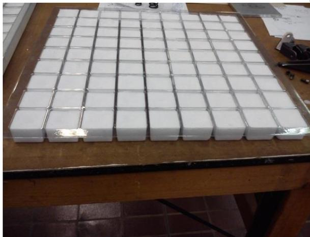
**Figura 44. Il modulo contenitore con PCM in fase solida**
