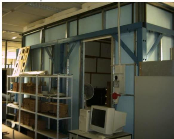
**Figura 52. Particolari costruttivi della camera climatica : struttura**
