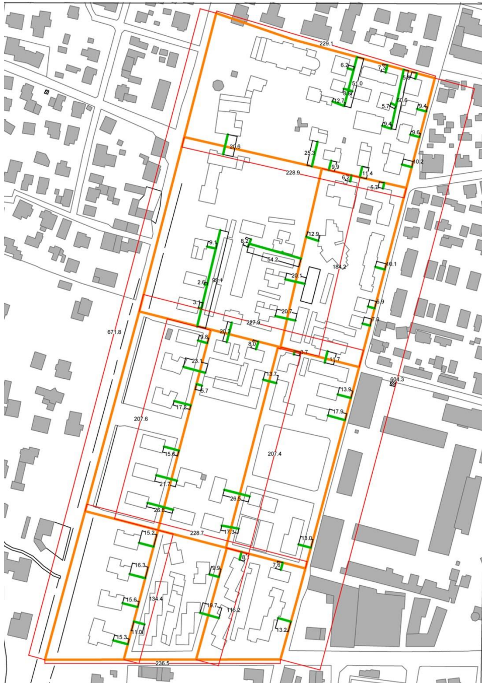
Figura 18. Configurazione rete a maglia
