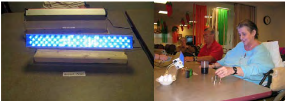
Figura 13 - Apparecchio di illuminazione customizzato LightBox con LED blu (470 nm)
