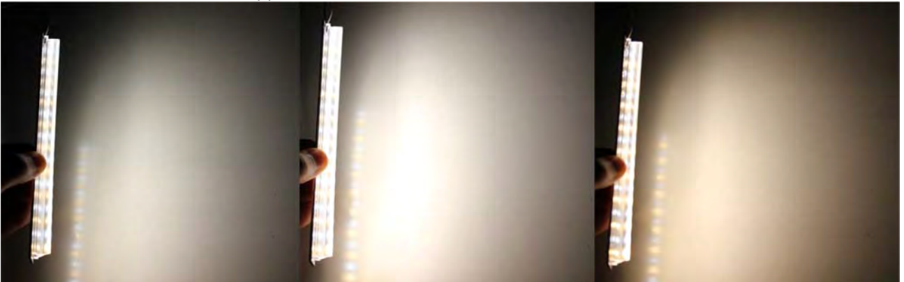
Figura 129 Valutazione delle proprietà di color mixing della lente per l'emissione indiretta
