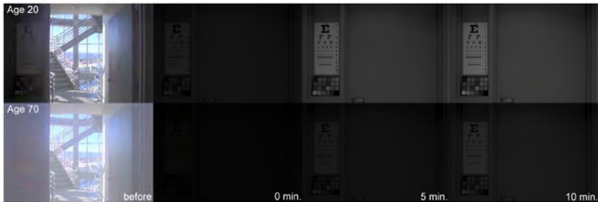
Figura 4- Simulazione dell'effetto dell'abbagliamento e dell'età nel meccanismo di adattamento al buio 14
