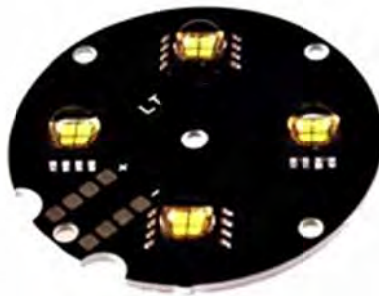
Figura 151 MCPB per la realizzazione di 3 spot a temperatura di colore variabile
