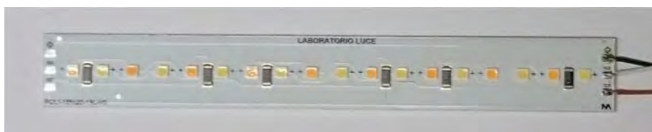
Figura 152 MCPB per illuminazione indiretta a temperatura di colore variabile
