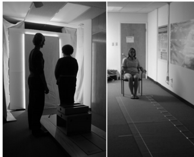
Figura 17 - Sistema di illuminazione laser a terra con tappeto Gaitrate di misura del passo
