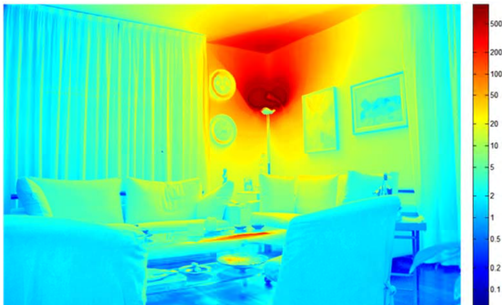
Figura 58 - Misura di luminanza del salotto da una vista frontale con il punto luce indiretto acceso (il valore massimo in corrispondenza della sorgente è stato saturato a 500 cd/m 2 )
