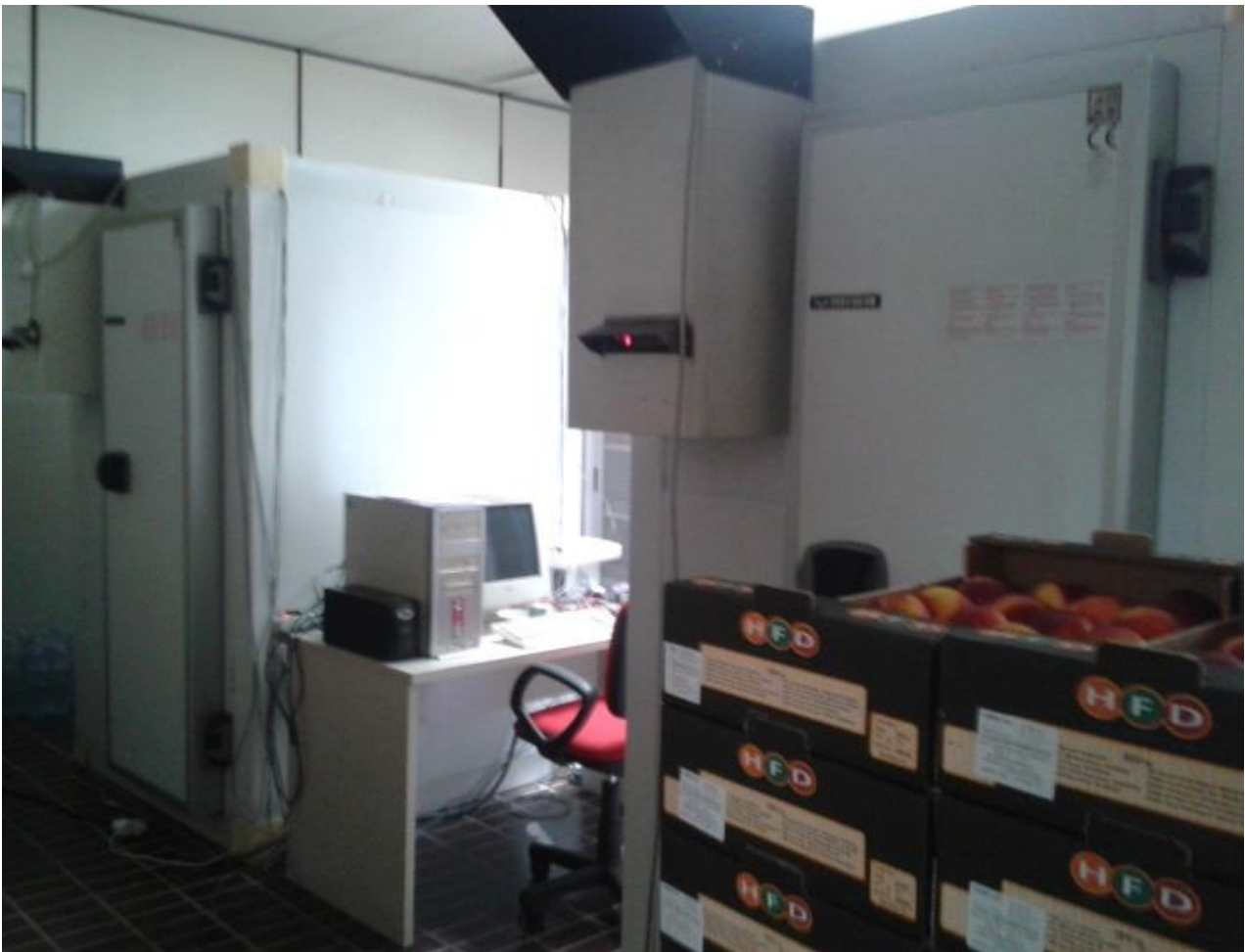
Figura 2.2.2.1: Laboratorio UNIPM con cella di riferimento e cella dotata di PCM durante la campagna sperimentale con pesche noce.
