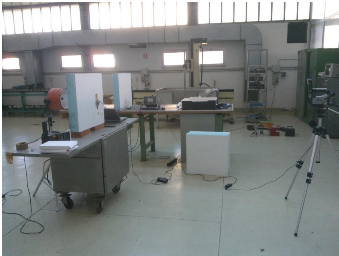
Figura 2.1.2.14: Setup sperimentale per l'esame termografico dei pannelli
