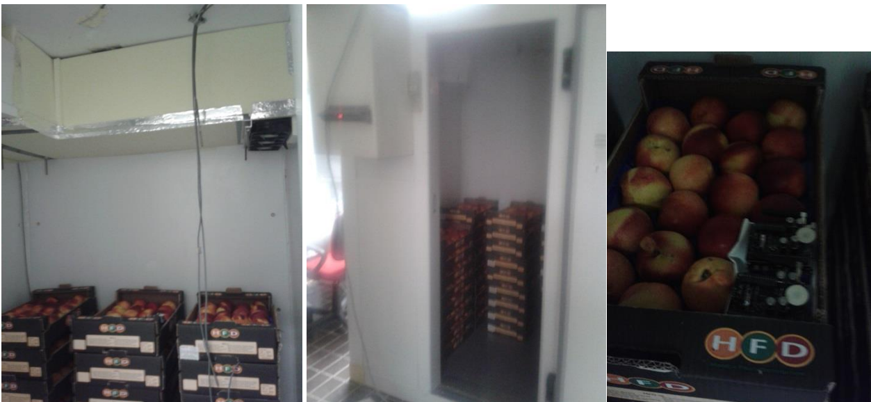
Figura 2.2.2.7: Pesche noce distribuite nelle due celle( con PCM a sinistra, cella di riferimento al centro), nella seconda fila di cassette dall'alto sono state sostituite alcune pesche con due nodi sensoriali per cella (vedi Figura a destra) ed un contenitore con una termoresistenza immersa nell'acqua per monitorare la temperatura delle pesche.
