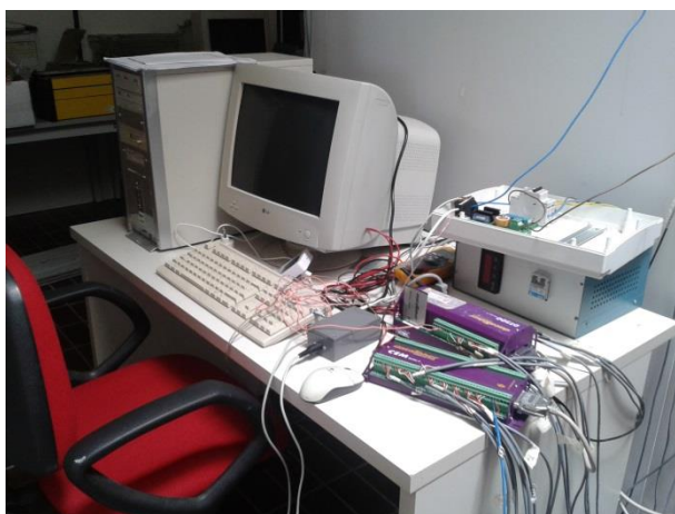
Figura 2.2.2.4: Sistema di monitoraggio termico ed energetico delle due celle presso UNIPM
