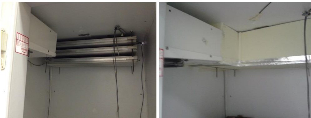
Figura 2.2.5: Fotografia dello scambiatore di PCM: (a) prima dell'applicazione del canale (b) con il canale per l'aria esterno.
