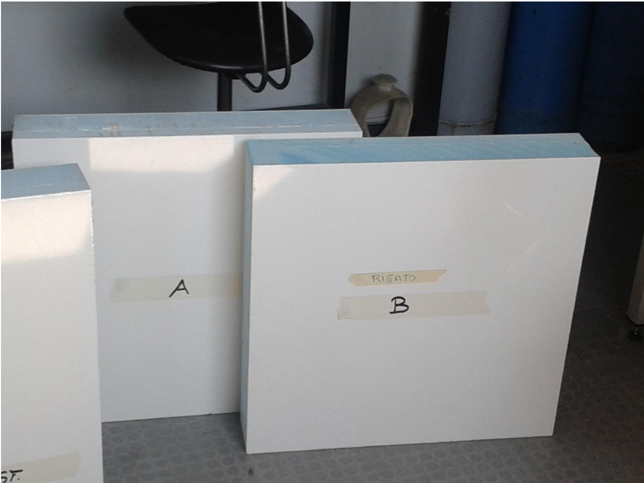
Figura 2.1.1.1: Vista complessiva dei prototipi A e B dei pannelli finiti, si nota che lo strato isolante è composto da due lastre di 70+30 mm di polistirene. Nel prototipo B le due lastre di polistirene sono state fresate con 14 canali su una e 13 sull'altra ed incollate con i canali in direzione perpendicolare in modo da realizzare una griglia.
