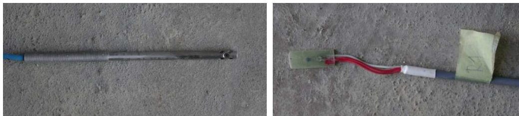
Figura 16. Termoresistenze per la misura della temperatura dell'aria (a) e per la misura della temperatura superficiale (b).
