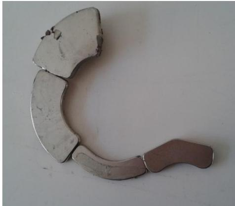
**Figura 25. Magneti permanenti distaccati dal supporto ferroso**
