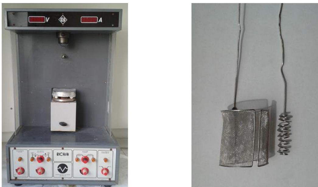
**Figura 15. Dispositivo per elettrodeposizione (a) e relativi elettrodi di platino (b)**
