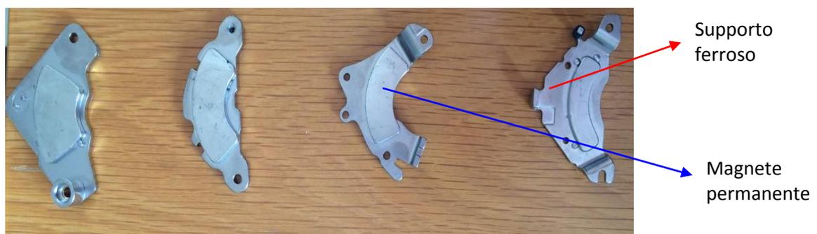
Figura 24. Magneti permanenti provenienti da Hard disk
