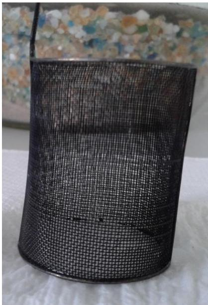
**Figura 18. Catodo dopo la deposizione dell'Sb**
