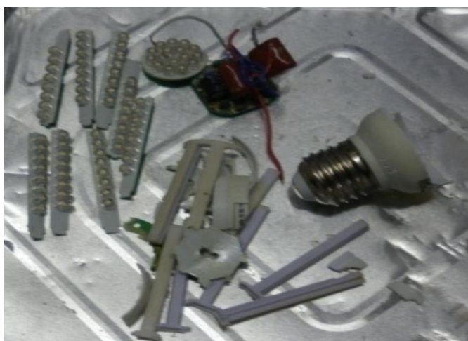
Figura 14. Materiali costitutivi la lampadina VALEX contenente LED THT
