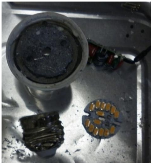
Figura 16. Materiali costitutivi la lampadina modello Wing Power contenente LED SMD
