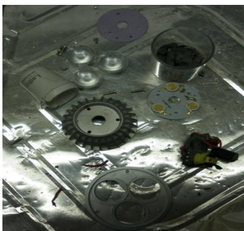
Figura 18. Materiali costitutivi la lampadina modello LEDION contenente LED PL
