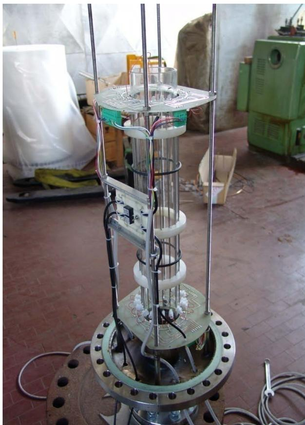
**Figura 1: Sonda capacitiva**
