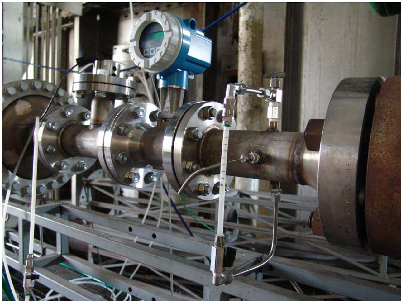
Figura 9: Indicatore graduato di livello per prove statiche
