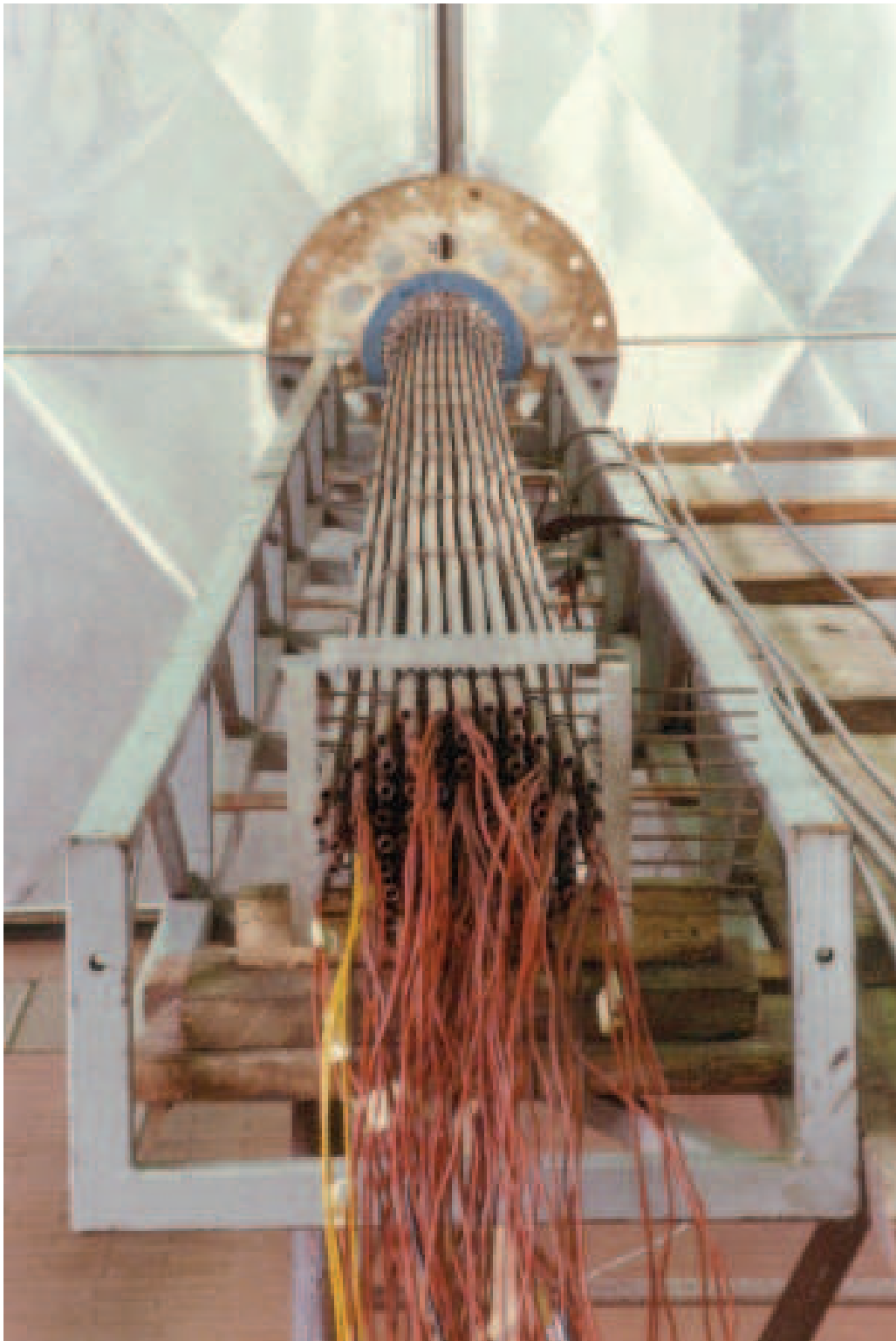
Figura 12 – Fascio di barre SPES-2 con termocoppie
