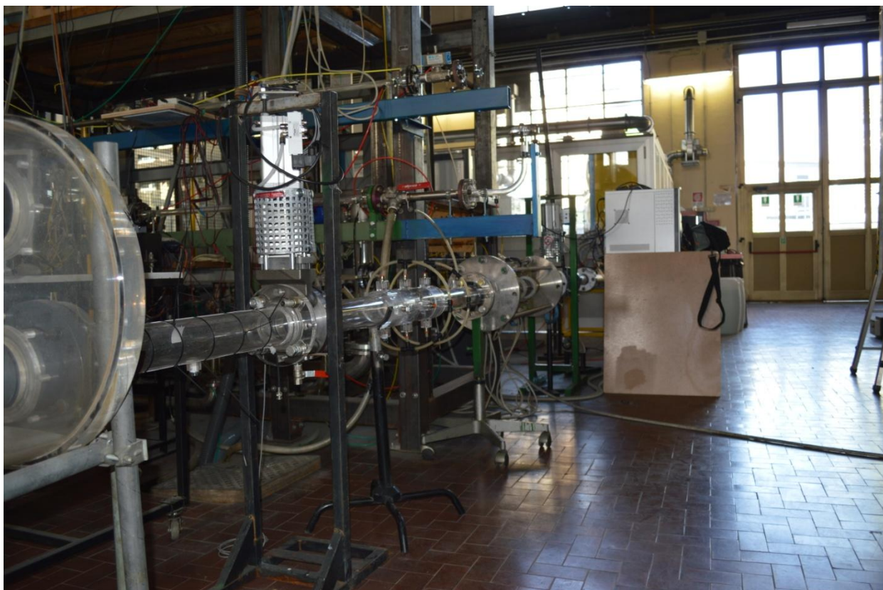
Fig. 4 Sezione di prova orizzontale (D=80 mm) con sonda ad impedenza SIET e Venturi reversibile.
