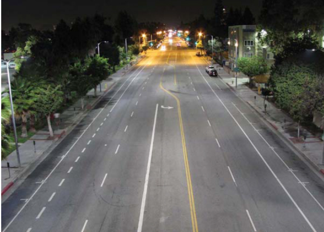
Figura 1. Illuminazione stradale a Los Angeles, Hoover Street. In alto (pag. precedente): le lampade ai vapori di sodio ad alta pressione preesistenti fornivano illuminazione disomogenea con aree scure. In basso: il retrofitting con lampade LED crea un illuminamento più uniforme del piano stradale ed una maggiore visibilità
