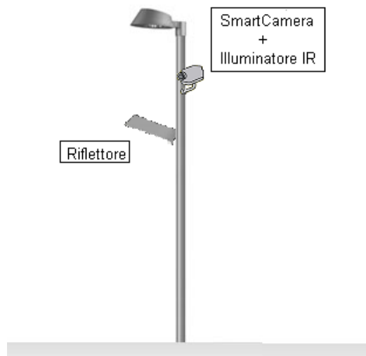
Figura 21: Misura di efficienza del gruppo luminoso con SmartCamera
